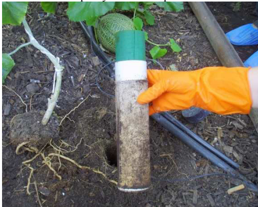
Рис. 5. Видалення капсули ГТА з товщі ґрунту
