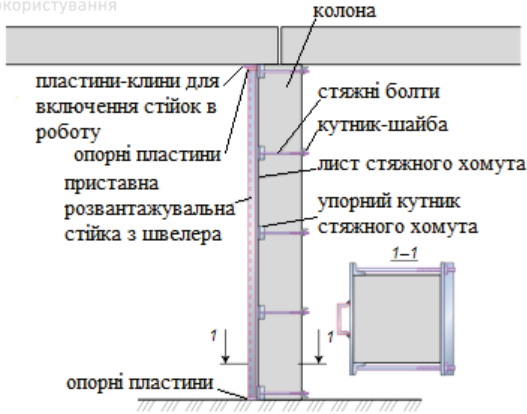
Рис. 5.69. Підсилення колон встановленням приставних розвантажувальних стійок
