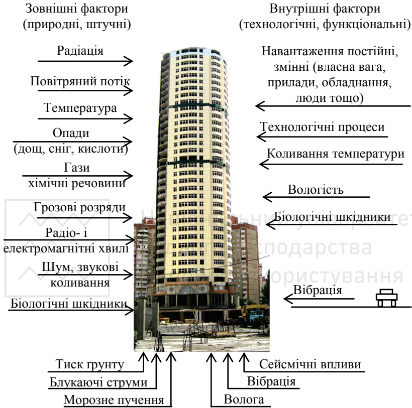
Рис. 2.3. Зовнішні і внутрішні фактори, які впливають на технічний стан будівель і споруд
