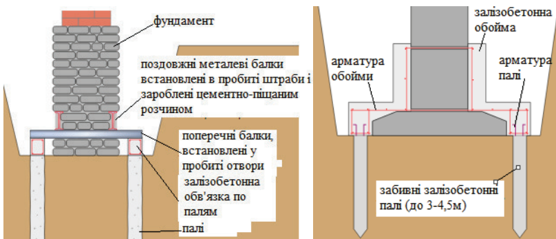
Рис. 5.8. Схеми підсилення стрічкових фундаментів палями
