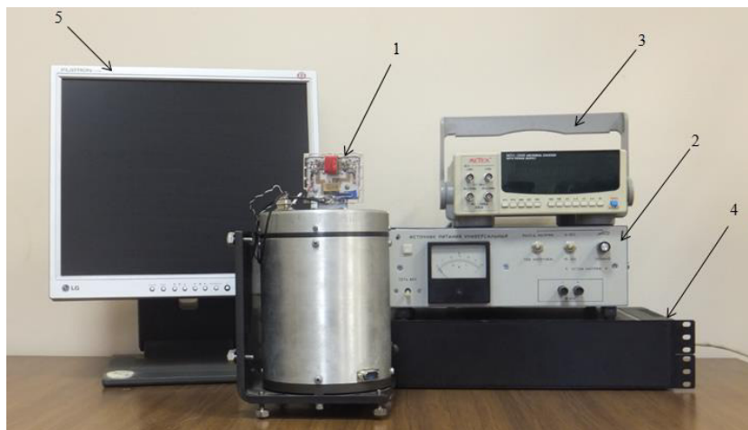
Рис. 19. Експериментальна установка для калібрування інерціальних сенсорів
