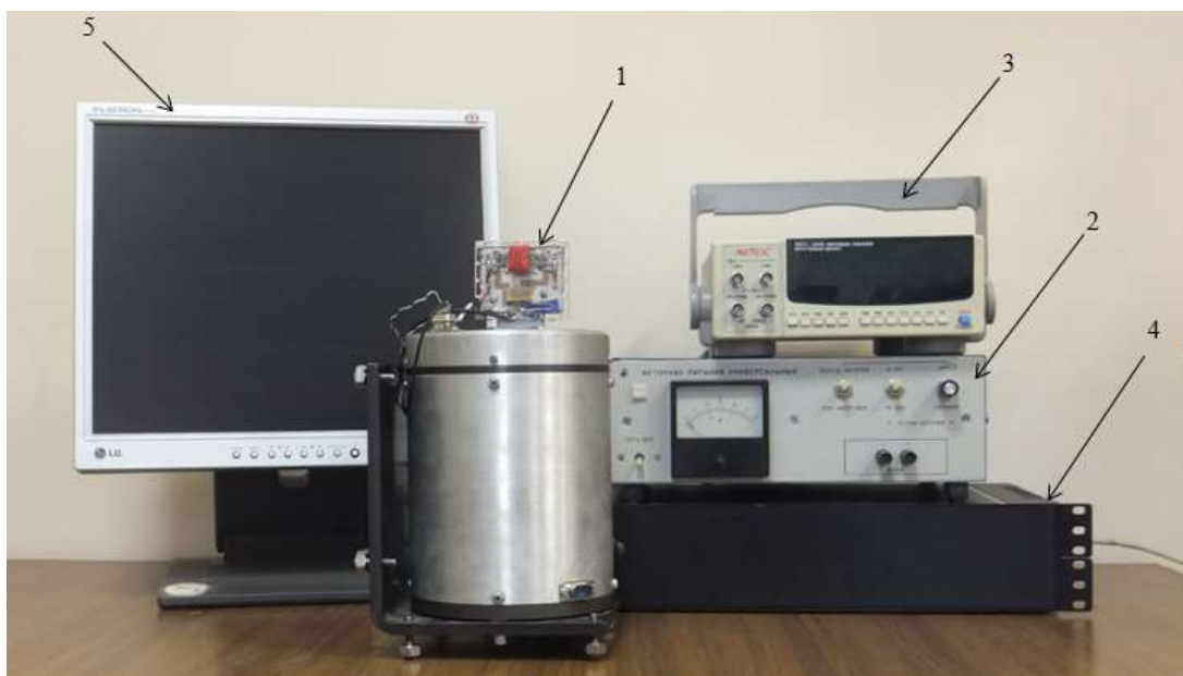
Рис. 6.16. Експериментальна установка: 1 – міні-центрифуга зі зразковим поворотним пристроєм та макетом IBM MPU 6050 ; 2 – джерело живлення PSM-6003 ; 3 – частотомір METEX MXC-260 ; 4 – електронний блок; 5 – комп'ютер
