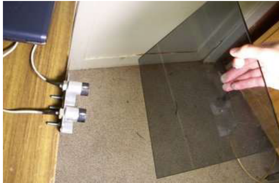
Рис. 6.6. Макетні випробування ультразвукового далекоміра з перешкодою з скла
