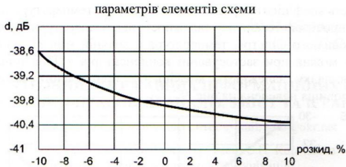
Рис. 6. Залежність коефіцієнта придушення завади смугопрпускового фільтра від розкиду всіх параметрів елементів схеми, крім С1, С2, R1 та R3
