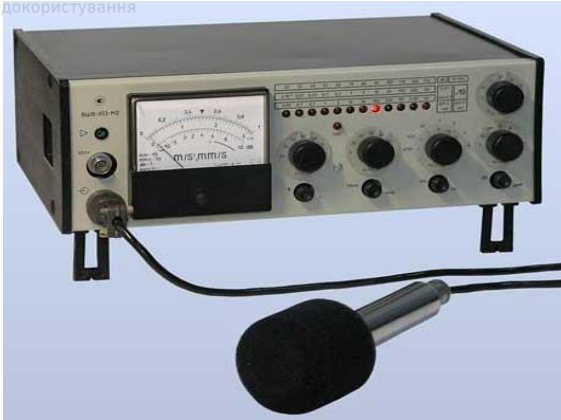
Рис. 5. Загальний вигляд вимірювача шуму та вібрації ВШВ-003
