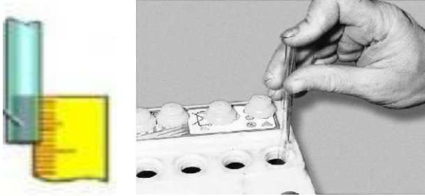
Рис. 4.5. Вимірювання рівня електроліту в акумуляторній батареї скляною трубкою
