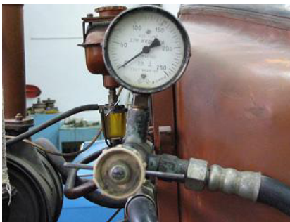
Рис. 2.4. Схема приєднання дроселя-витратоміра КИ-1097 для визначення технічного стану гідророзподільника гідравлічної системи:
