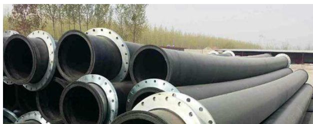
Рис. 9. Поліетиленові труби для спорудження берегового пульпопроводу
