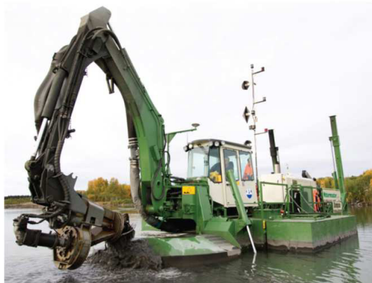
Рис. 2. Багатофункціональний земснаряд «Watermaster Classic V»
