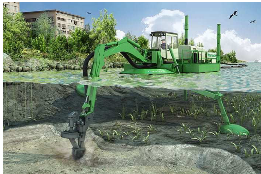
Рис. 6. Закріплення земснаряду над забоем
