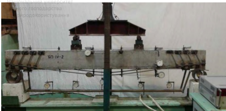
Рис. 1.2. Загальний вигляд випробування балки БП-IV-2
