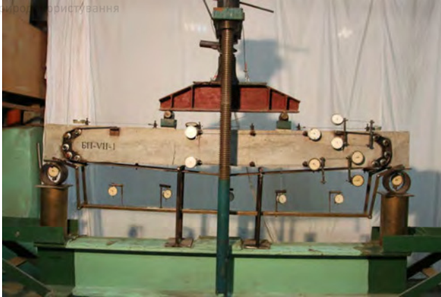
Рис. 3. Випробування залізобетонних балок, підсилені зовнішньою сталевую гнучкою арматурою, серії БП-VII
