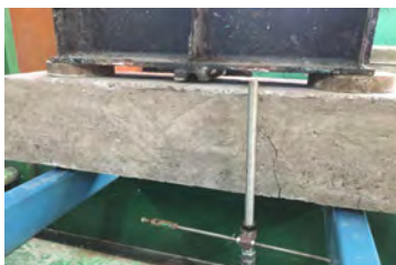
Рис. 5. Руйнування дослідних зразків Б-1п та Б-2п
