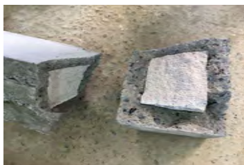
Рис. 6. Руйнування дослідних зразків Б-1 та Б-2
