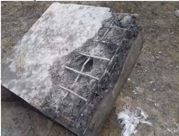
Рис. 3 – Ураження плити П-2 бойком товщиною 120 мм
