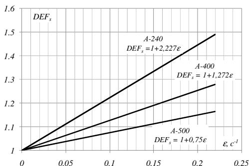
Рис. 3 Зміна коефіцієнта зміщення арматурної сталі залежно від швидкості зміни деформацій
