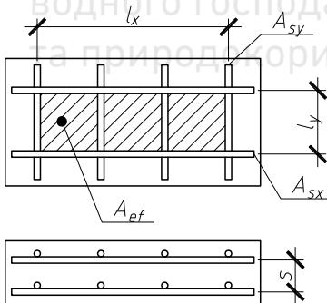
Рис. 2 – До визначення приведеної міцності бетону
