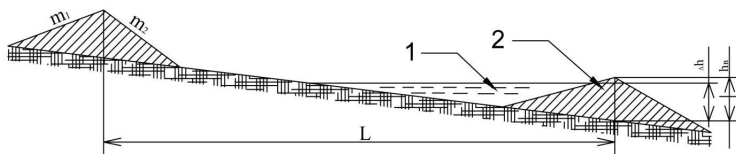
Рис. 1. Схема горизонтальних валів-терас. 1 – ставочок; 2 – вал; L – ширина тераси; h_b – висота вала; \Delta h – робоча глибина.
