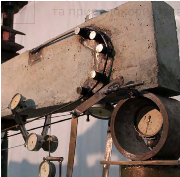
Рис. 2. Загальний вигляд підсиленої серії балок під час випробування.
