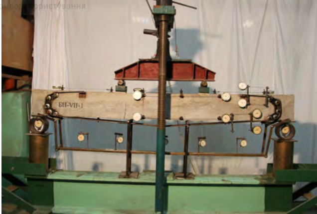
Рис. 3. Випробування залізобетонних балок, підсилених зовнішньою сталевую гнучкою арматурою, серії БП-VII
