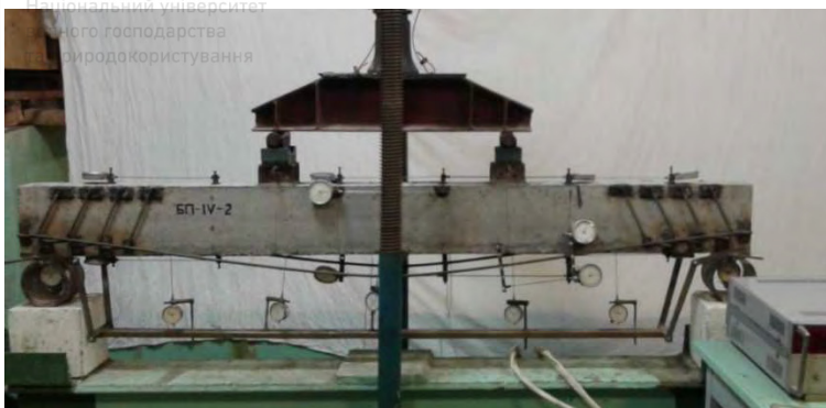
Рис. 1.2. Загальний вигляд випробування балки БП-IV-2
