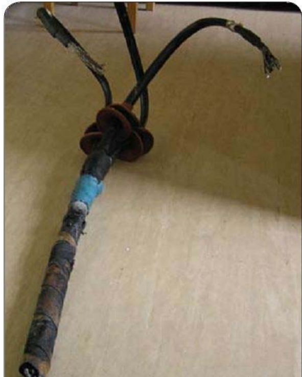
Рис. 1.10. Пошкоджений кабель напругою 6 кВ
