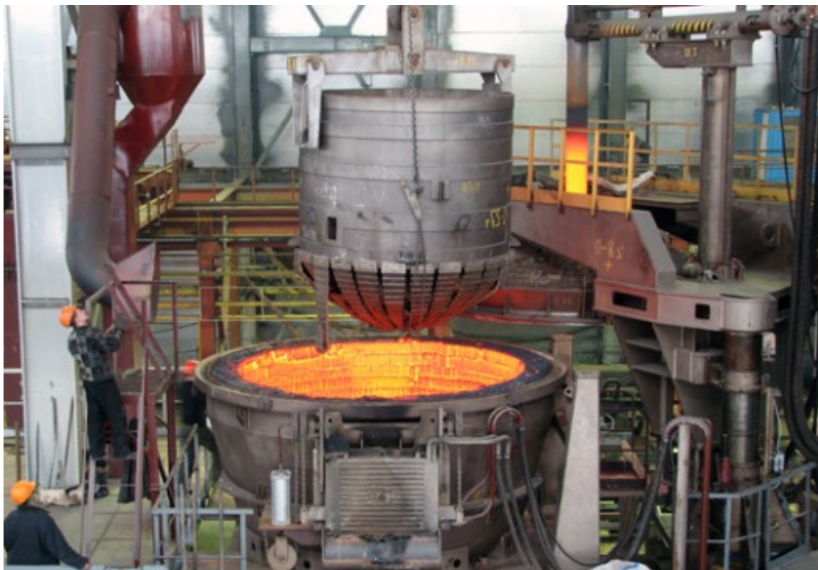
Рис. 1.5. Дугова сталеплавильна піч (шихта плавиться високовольтною електричною дугою)
