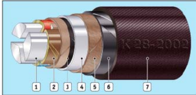
Рис. 1.6. Структура броньованого кабелю ААБл (6, 10 кВ):
