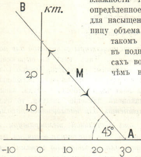
Черт. 36. Графическое изображеніе адиабатнаго измѣненія температуры въ поднимающейся или опускающейся массѣ воздуха.
