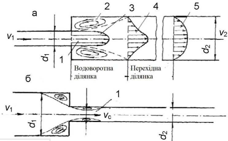
Рис. 2.2. Схеми раптового розширення (а) і раптово звуження (б) трубопроводу: 1 – транзитний потік; 2 – вихрова ділянка; 3, 4, 5 – епюри швидкостей; V_1 – середня швидкість до зміни перерізу; V_2 – середня швидкість після зміни перерізу
