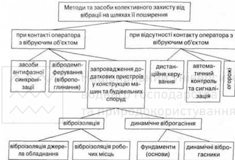
Рис. 3.2. Класифікація методів та засобів захисту від вібрації
