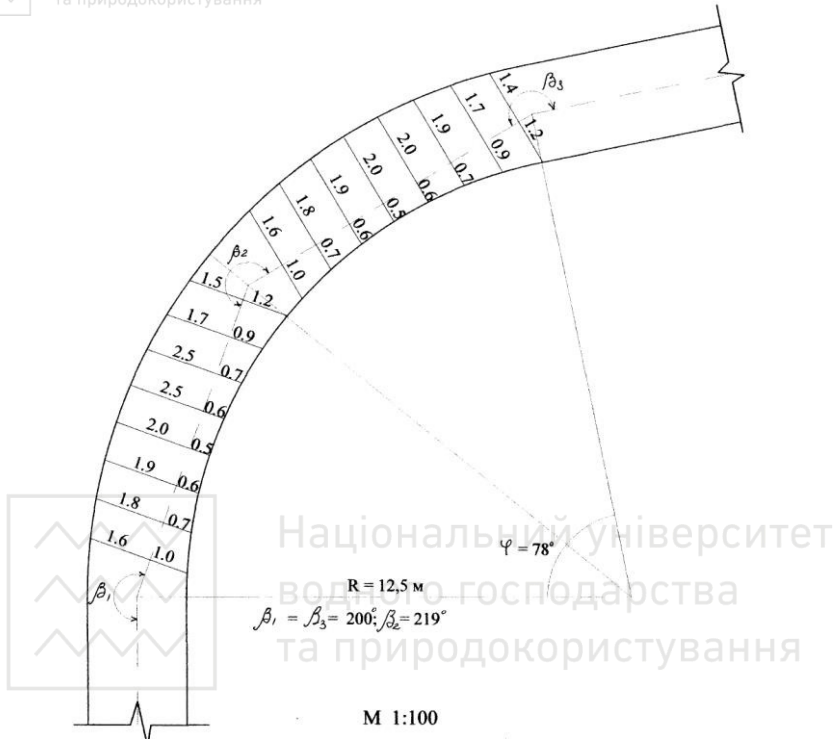
Рис. 6.1. Ескіз проведення криволінійної ділянки виробки
