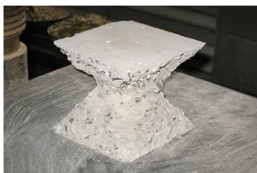
Рис. 2.1. Схема випробування та руйнування бетонного кубика (а) та натуральний вигляд кубика до і після руйнування (б)
