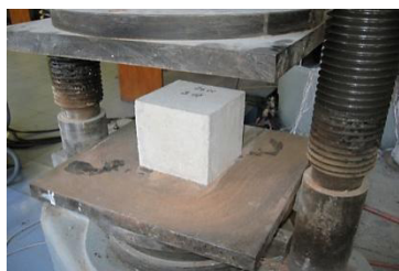
Рис. 2.1. Схема випробування та руйнування бетонного кубика (а) та натуральний вигляд кубика до і після руйнування (б)
