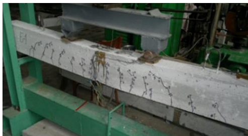
Рис. 3.2. Характер руйнування балок по нормальним перерізам
