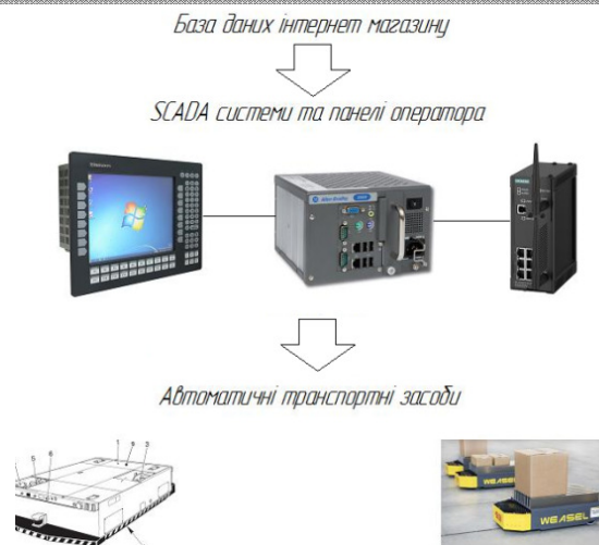
Рис. 1. Структура комп'ютерно-інтегрованої системи управління складу Інтернет-магазину
