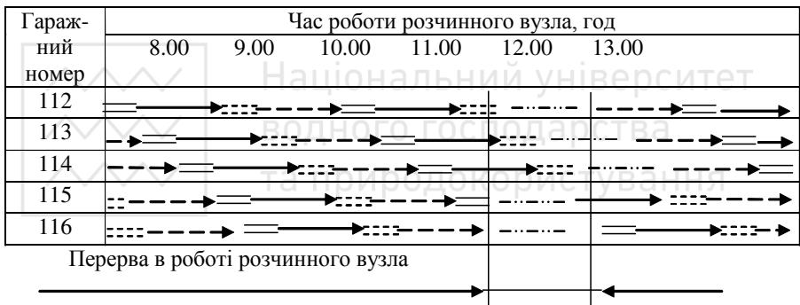
Рис. 7.1. Суміщений графік роботи автомобілів і розчинного вузла:
