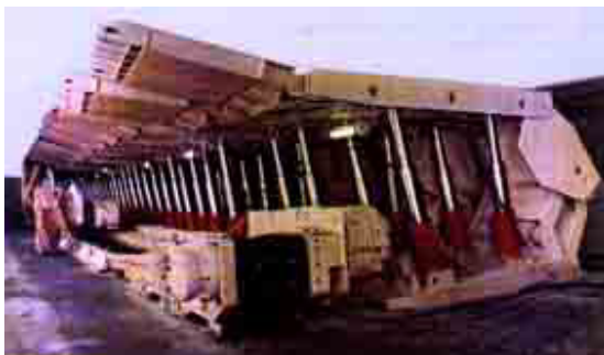
Рис. Д.13. Очисний комплекс 1МК85Б
