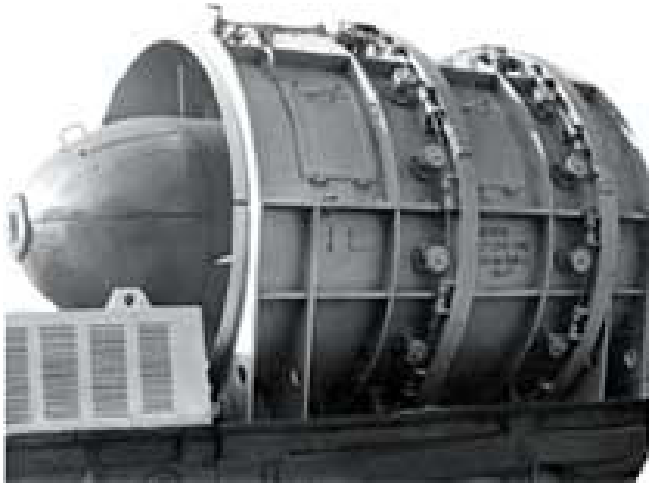
Рис. Ж.11. Шахтний вентилятор головного провітрювання ВОД-21М
