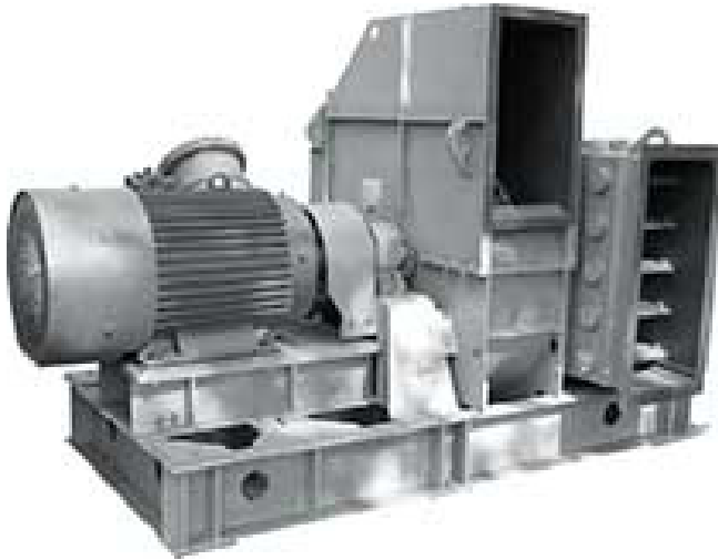
Рис. Ж.26. Шахтний газовідсмоктуючий вентилятор УВЦГ-7А Таблиця Ж.26
