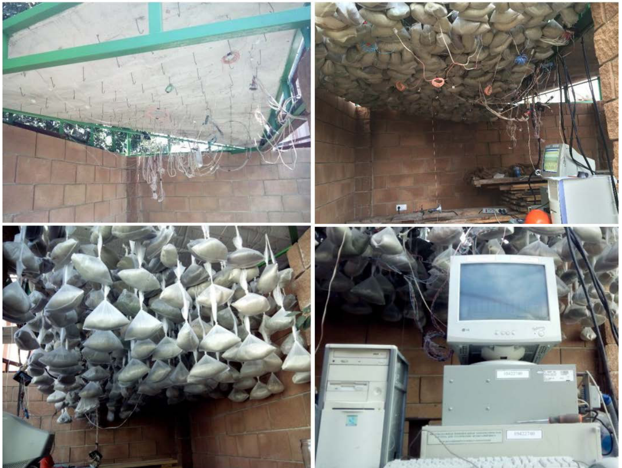
Рисунок 5 – Загальний вигляд випробування оболонки у формі гіпара
