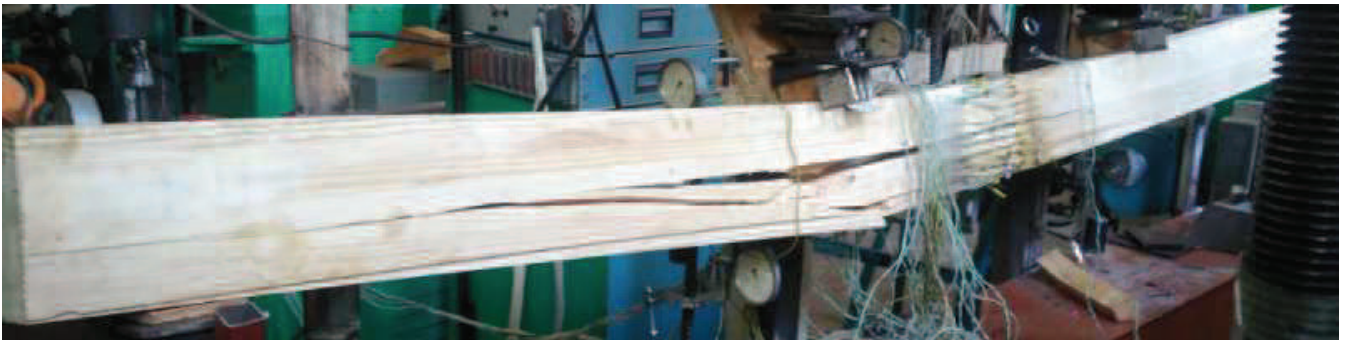
Рис. 2 – Характер руйнування дощатоклеєної балки БДК-2 після дії одноразових навантажень
