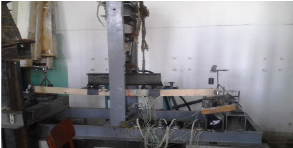
Рисунок 2.8 – Загальний вигляд установки випробувань балки першої серії з цільної деревини Б-1
