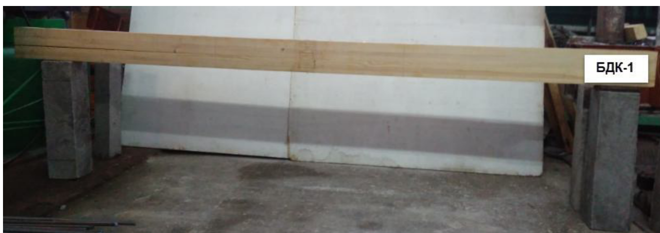
Рисунок К.1 – Характер руйнування балки БДК-1
