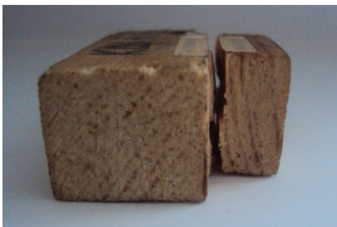
Рисунок Д.6 – Характер руйнування зразка КШ – 20 (0,2-0,9)
