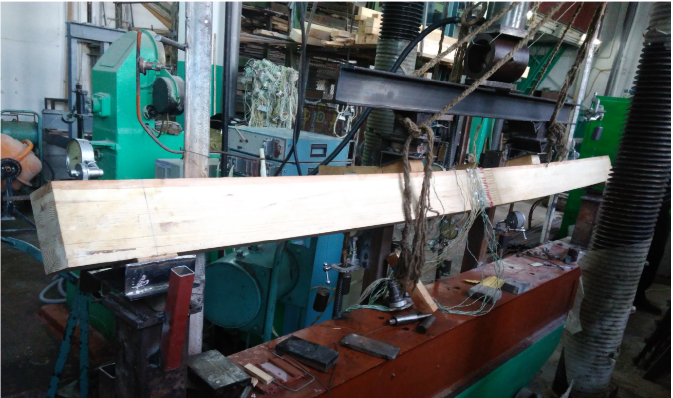
Рисунок 2.10 – Загальний вигляд установки випробувань дощатоклеєної балки другої серії БДК-3
