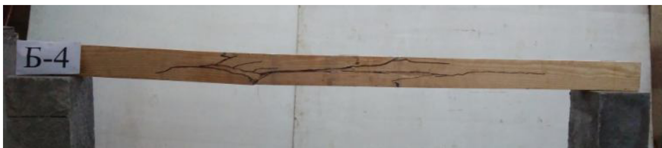
Рисунок Е.4 – Характер руйнування балки Б-4
