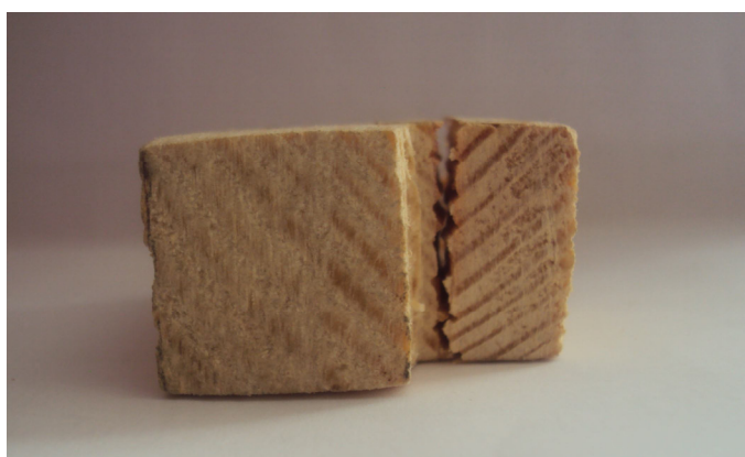
Рисунок Д.5 – Характер руйнування зразка КШ – 19 (0,2-0,8)
