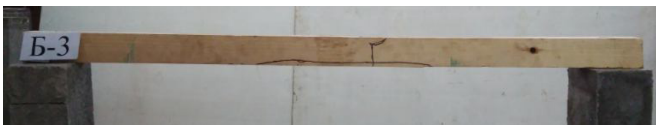
Рисунок Е.3 – Характер руйнування балки Б-3
