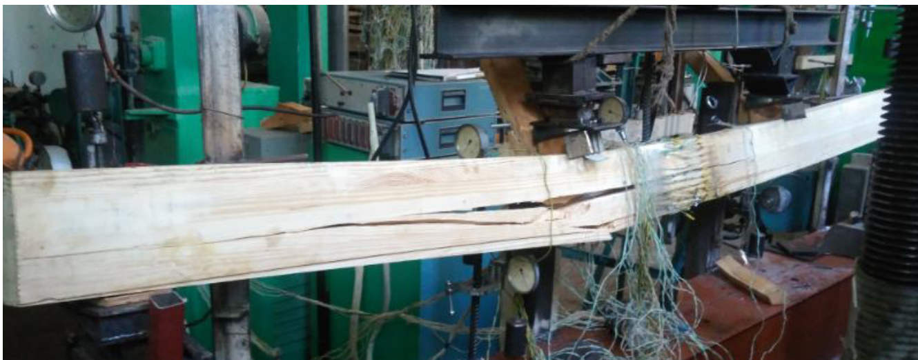
Рисунок 5.18 – Характер руйнування дощатоклеєної балки БДК-2 після дії одноразових навантажень
