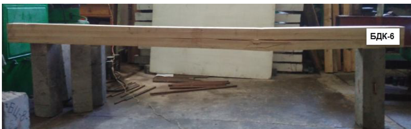
Рисунок К.2 – Характер руйнування балки БДК-6
