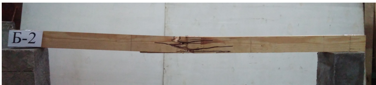
Рисунок Е.2 – Характер руйнування балки Б-2
