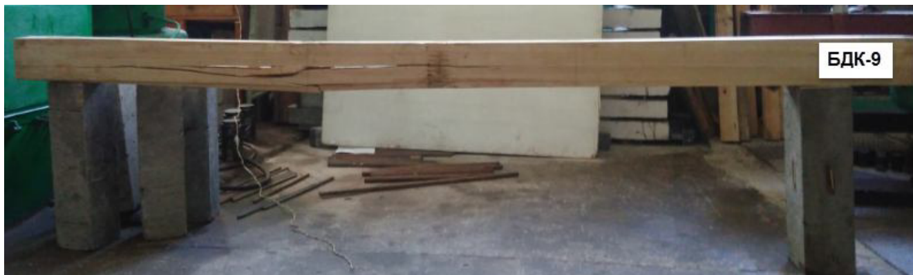
Рисунок К.4 – Характер руйнування балки БДК-9
