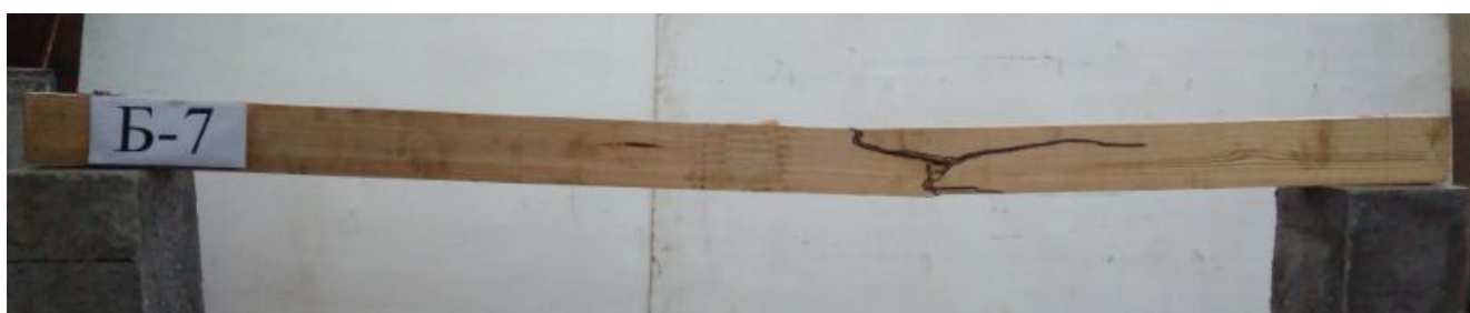
Рисунок Е.7 – Характер руйнування балки Б-7
