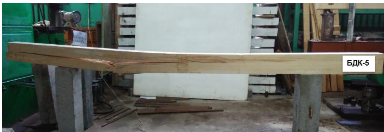
Рисунок 5.20 – Характер руйнування балки БДК-5 після дії повторних малоциклових навантажень
