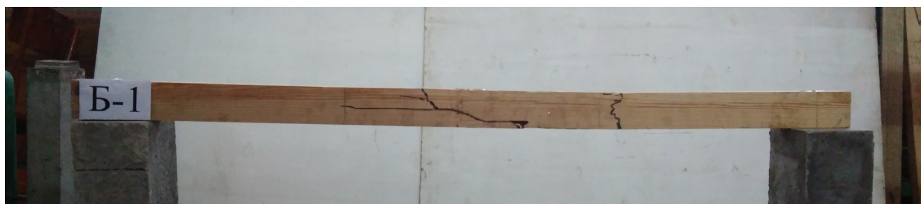
Рисунок Е.1 – Характер руйнування балки Б-1
