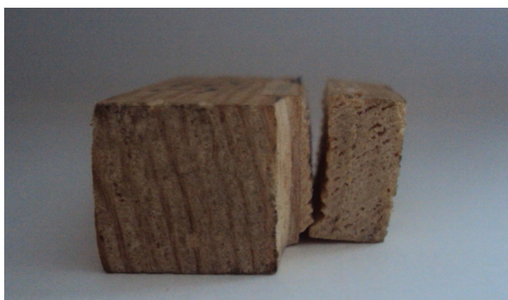
Рисунок Д.2 – Характер руйнування зразка КШ – 16 (0,2-0,5)
