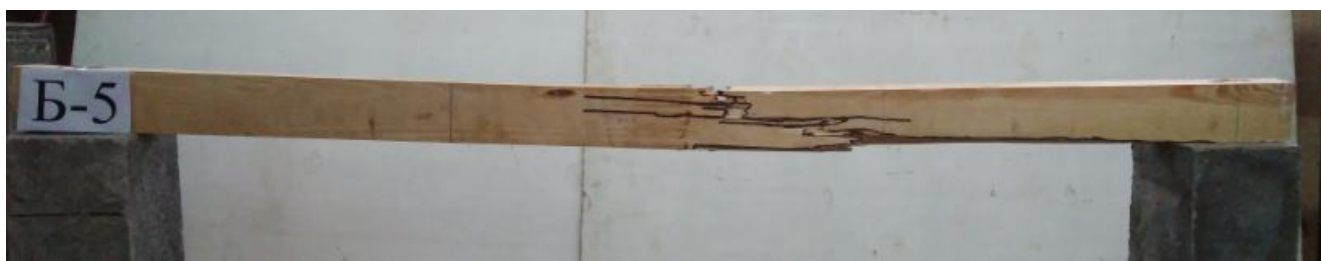
Рисунок Е.5 – Характер руйнування балки Б-5
