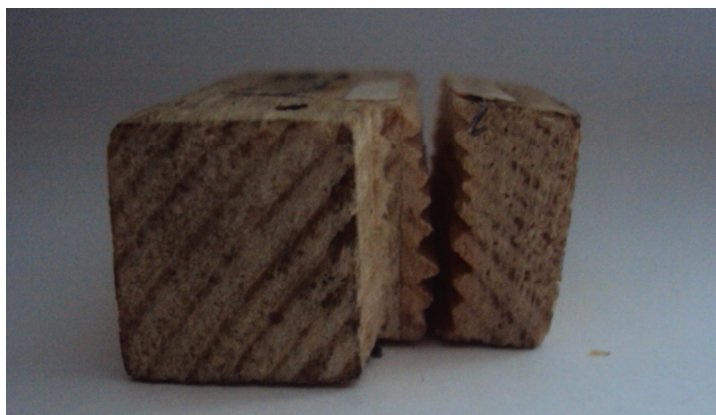
Рисунок Д.1 – Характер руйнування зразка КШ – 15 (0,2-0,4)
