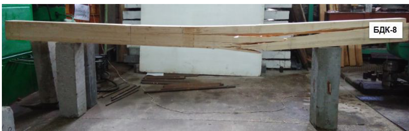
Рисунок К.3 – Характер руйнування балки БДК-8
