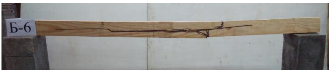
Рисунок Е.6 – Характер руйнування балки Б-6
