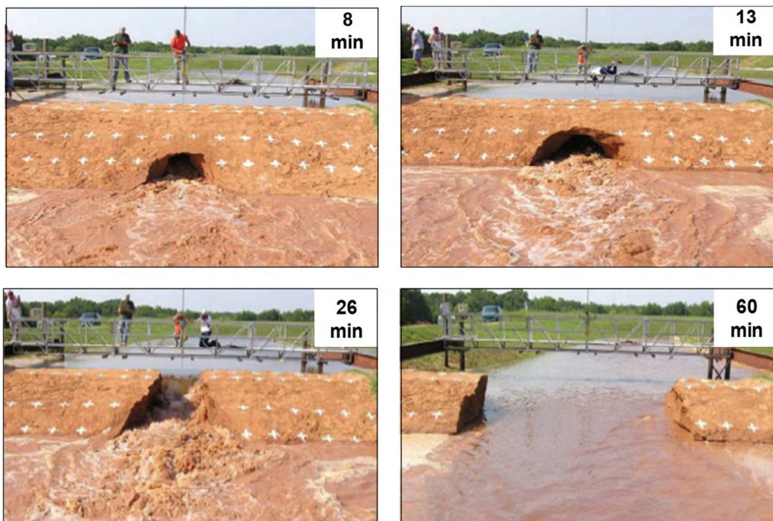
Рисунок 1.19 – Зосереджений шлях фільтрації через експериментальний насип в Гідротехнічній дослідницькій лабораторії в часі (146)
