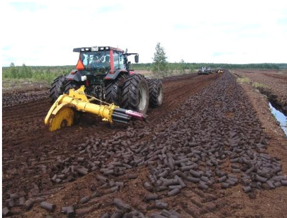
Рис. 2.4. Вистилання кусків торфу при фрезформовочному способі видобування (фото з джерела [19])
