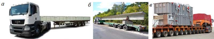
Рис. 8.3. Автомобільний транспорт, що використовується при будівництві гідротехнічних споруд: а – бортові автомобілі; б – напівпричеми різного призначення; в – великовантажні трейлери
