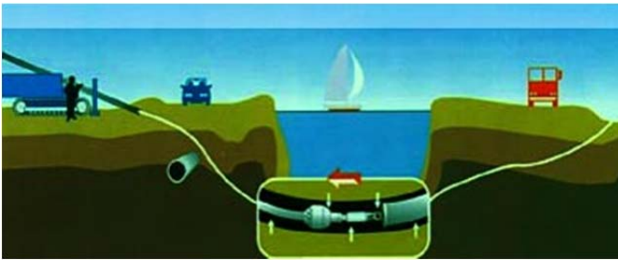
Рис. 1.139. Схема протягування трубопроводу
