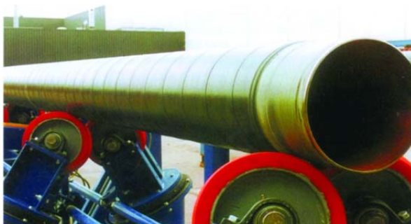
Рис. 1.81. Нанесення протикорозійної ізоляції на сталеві труби у заводських умовах
