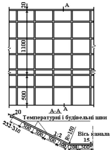
Рис. 1.22. Конструкції кріплення каналу монолітним бетоном
