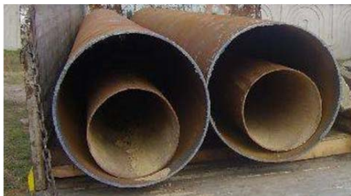
Рис. 1.146. Сталеві робочі труби у кожухах
