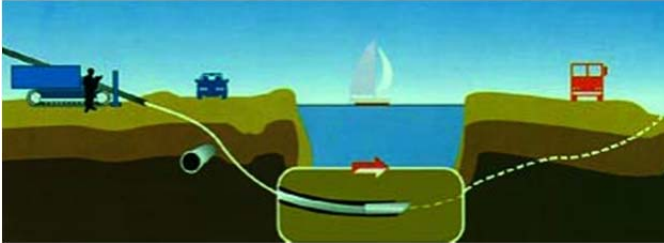
Рис. 1.135. Схема буріння пілотної свердловини
