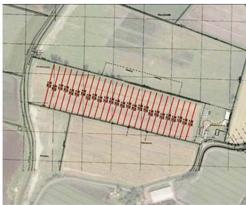
Рис.1.194. Електронний виконавчий план улаштування дренажу
