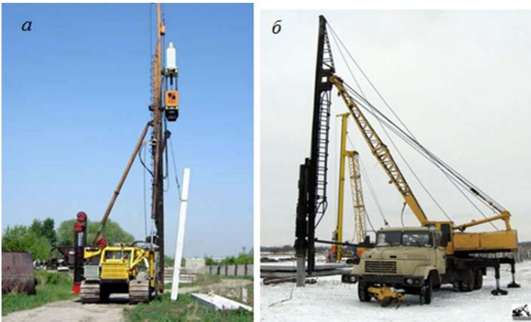
Рис. 2.29. Самохідні палейні установки: а – на тракторі; б – на автомобілі
