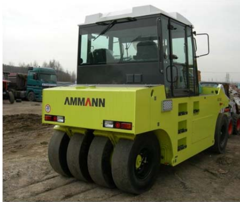
Рис. 1.223. Ущільнення ґрунту в насипу греблі самохідним пневмоколісним котком
