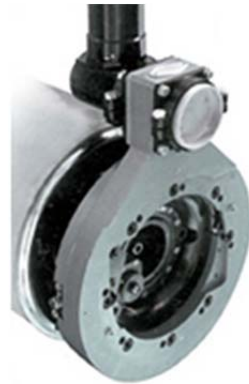
Рис. 1.112. Торцювання крайки сталеві труби
