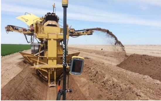
Рис. 1.13. Вирізання русла каналу у насипу роторним багатокішцевим екскаватором з пасивними укісниками
