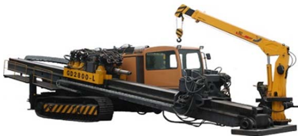
Рис. 1.141. Установка направлено буріння з крановим обладнанням
