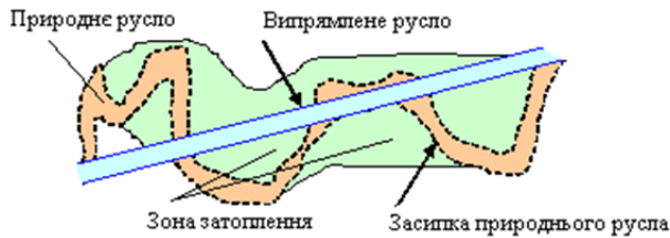
Рис. 2.77. Схема випрямлення річки
