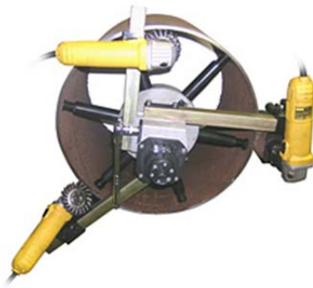
Рис. 1.111. Пристрій для очищення торців труб
