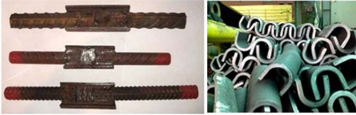
Рис. 3.34. Зварювання арматурних стержнів ванним способом
