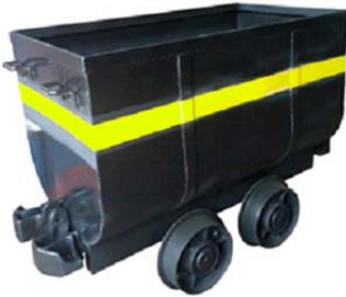
Рис. 3.79. Вагонетка з глухим кузовом і установка для їх перекидання
