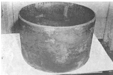
Рис. 1.183. Стінове кільце з полімерсклофібробетону
