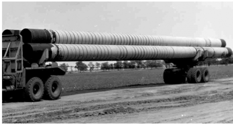
Рис. 1.83. Сталеві труби з бітумно-полімерною ізоляцією і зовнішнім захисним шаром
