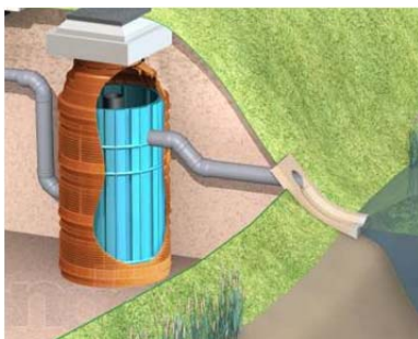
Рис. 2.100. Загальний вигляд колодязя-відстійника
