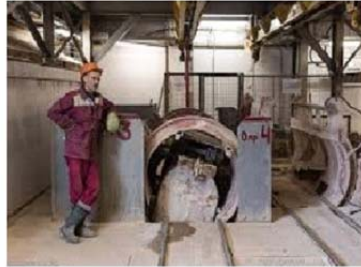
Рис. 3.79. Вагонетка з глухим кузовом і установка для їх перекидання
