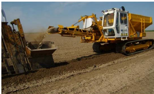
Рис. 1.188. Гусеничний візок для транспортування і навантаження в бункер фільтруючого матеріалу
