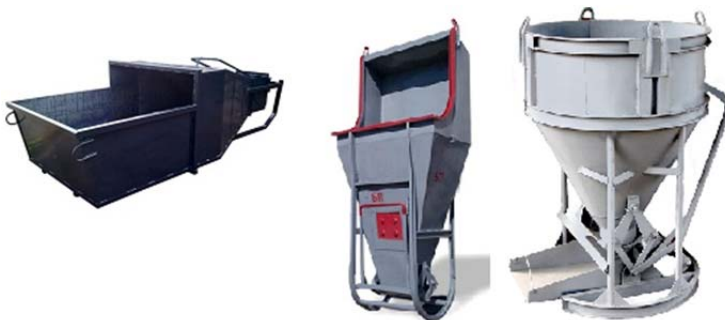
Рис.3.41. Цебри для переміщення бетонної суміші
