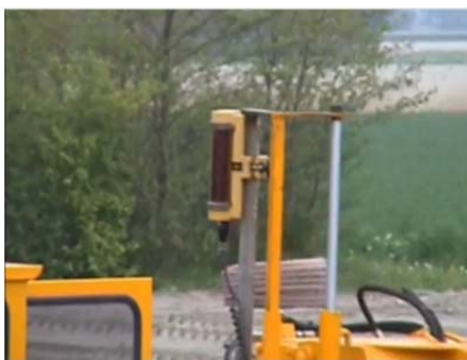
Рис. 1.192. Приймач лазерної системи на дреноукладачі
