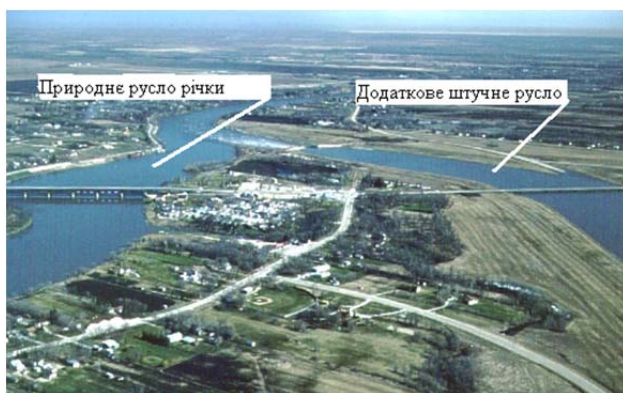
Рис. 2.75. Схема влаштування додаткового русла
