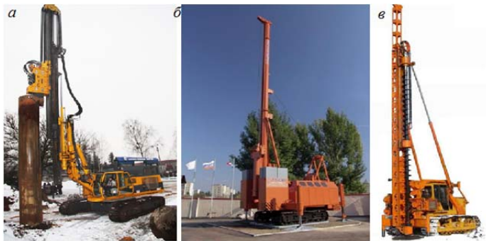
Рис. 2.31. Обладнання для занурення палей: а – установка вібраційного занурення; б – палевдавлювальна установка; в – установка для загвинчування палей
