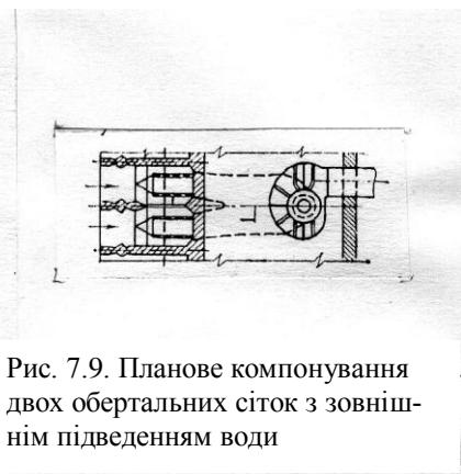
Рис. 7.9. Планове компонування двох обертальних сіток з зовнішнім підведенням води
