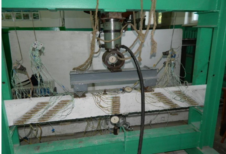
Рисунок 3 - Загальний вигляд випробування дослідних балок
