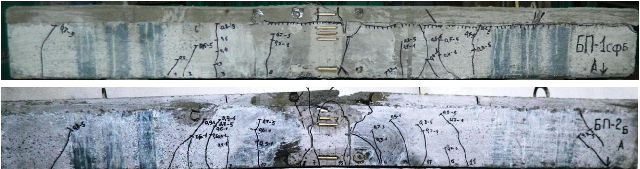
Рисунок 8 – Характер руйнування та тріщиноутворення підсилених балок БП-1 СФБ БП-2 Б
