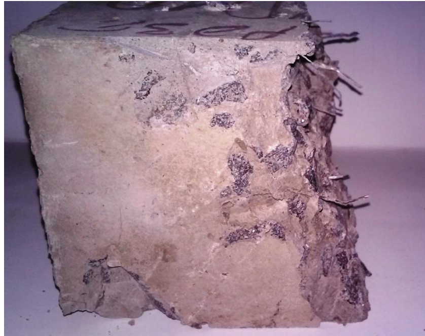
Рисунок 2.26 – Вигляд руйнування куба із фіброю після випробування
