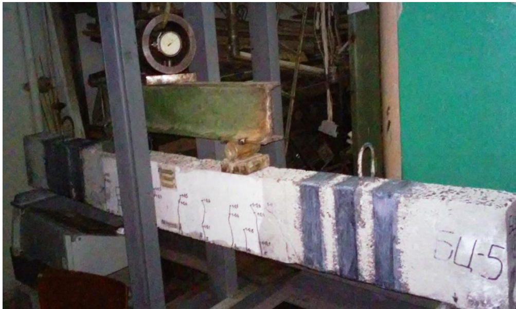
Рисунок 2.13 – Загальний вигляд балки підсиленої системами Sika ® CarboDur ® S-512 та SikaWrap ® -230 C/45 під навантаженням
