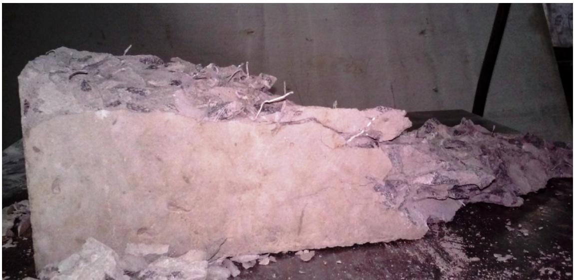
Рисунок 2.27 – Зруйнована призма із фібровим армуванням із характерним розташуванням фібр у тілі бетону
