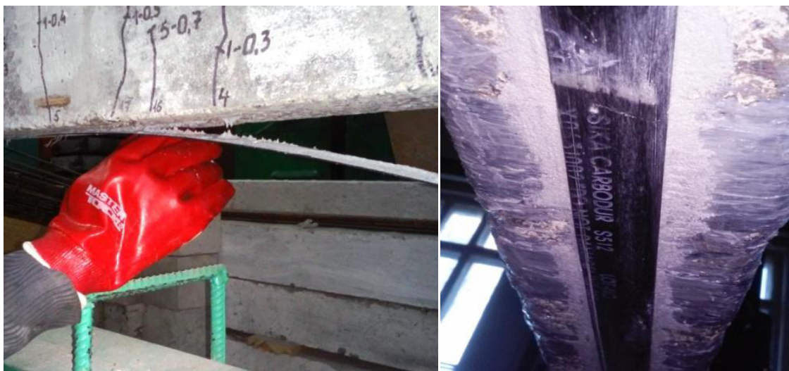
Рисунок 2.10 – Приклеювання стрічки Sika® CarboDur® S-512 до дослідних балок під навантаженням
