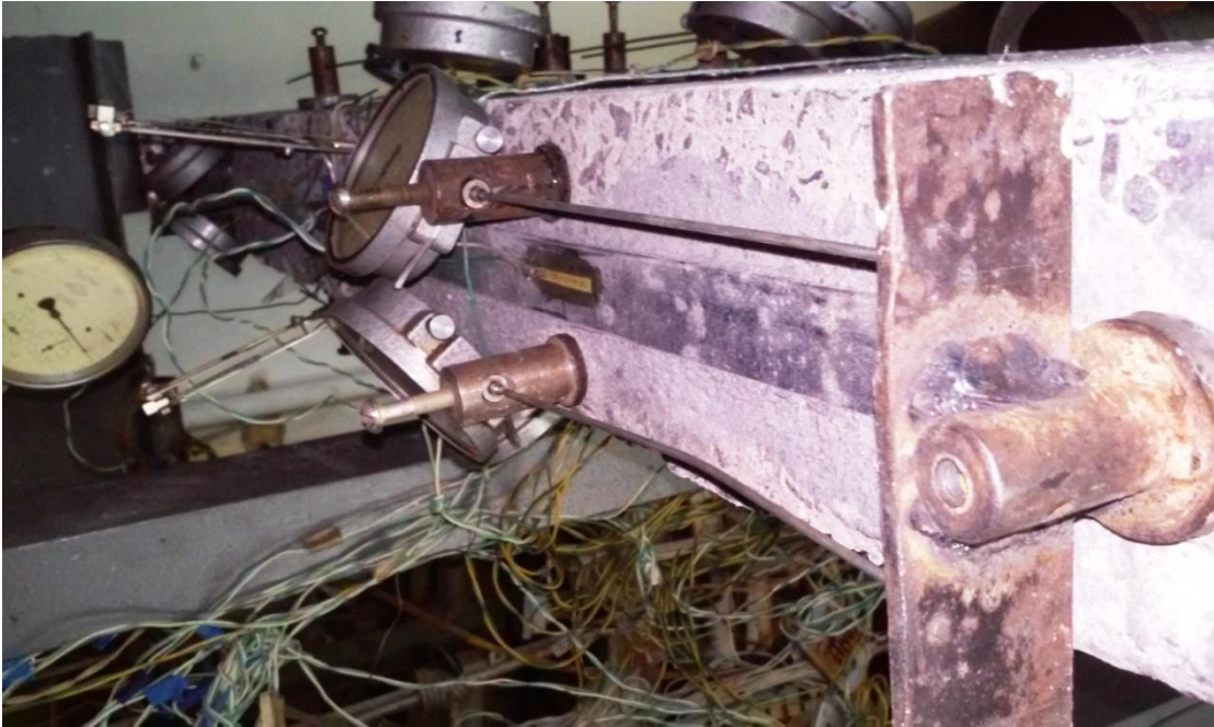
Рисунок 3.37 – Індикатори та датчики для виміру сумісного деформування стрічки та бетону балки
