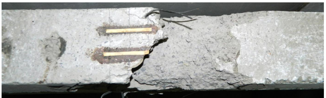
Рисунок 3.9 – Руйнування підсиленої балки БП-2 Б за дії однократного навантаження
