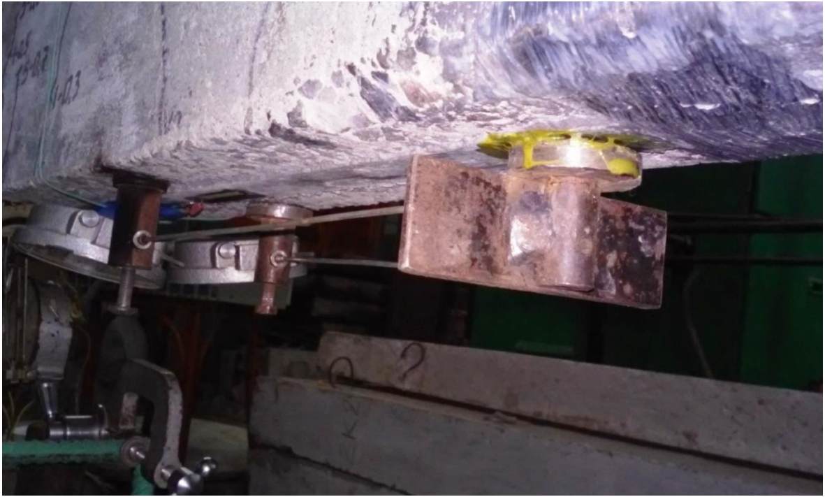
Рисунок 2.24 – Розміщення індикаторів для вимірювання зміщення композитної стрічки підсилення відносно тіла бетону
