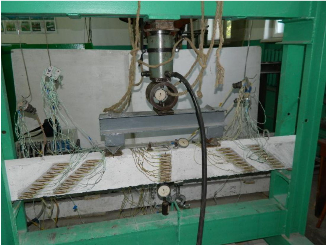
Рисунок 2.22 – Вигляд дослідної установки та розташування приладів на балці без підсилення
