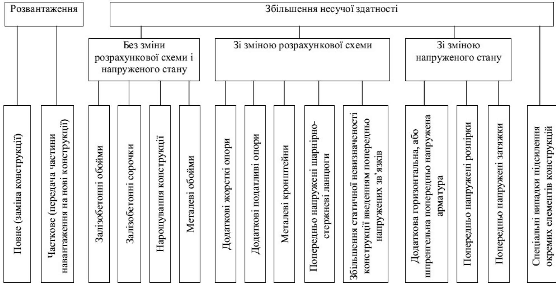
Рисунок 1.1 – Методи підсилення залізобетонних конструкцій (за Бліхарським З.Я.) [24].
