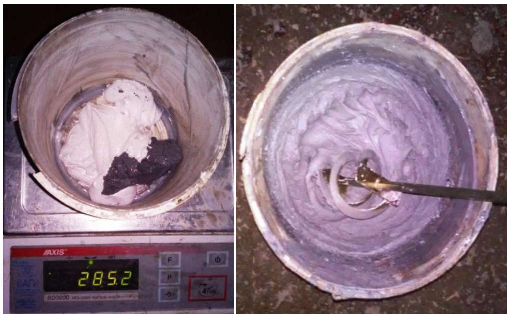
Рисунок 2.7 – Зважування та змішування компонентів клею А та В (смоли та затверджувача)
