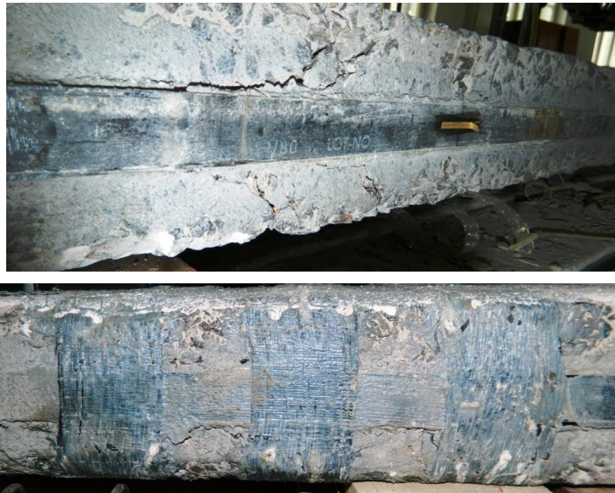
Рисунок 3.8 – Руйнування підсиленої балки БП-1 СФБ за дії однократного навантаження (зміщення та відрив стрічки від тіла балки)
