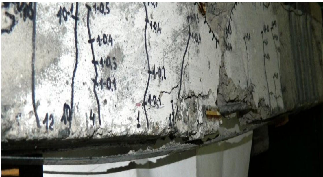
Рисунок 3.32 – Руйнування балки БЦП 0,6-5Б та БЦП 0,6-6 СФБ підсиленої під навантаженням за дії малоциклових впливів (зміщення полотна та відрив стрічки від тіла балки)
