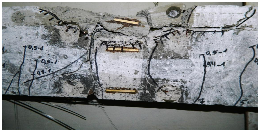
Рисунок 3.8 – Руйнування підсиленої балки БП-1 СФБ за дії однократного навантаження (зміщення та відрив стрічки від тіла балки)
