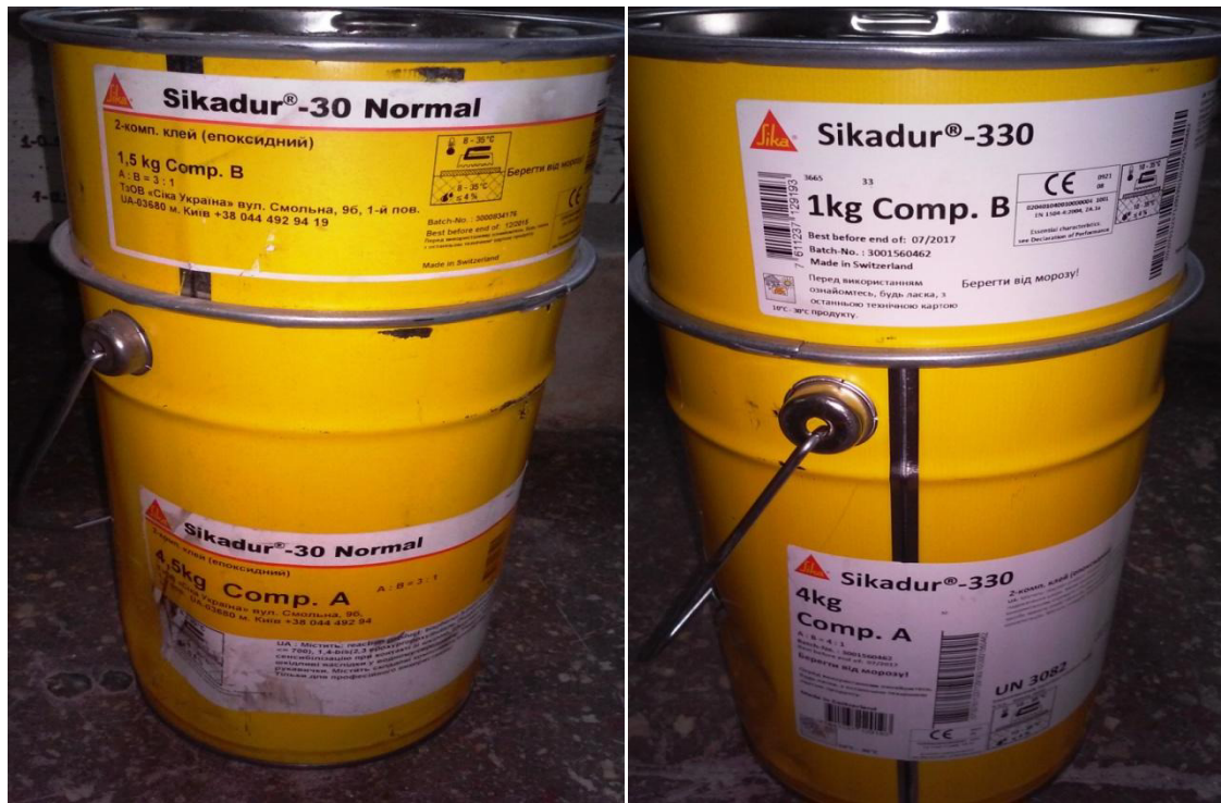
Рисунок 2.2 – Двохкомпонентні клеї Sikadur ® -30 та Sikadur ® -330 (компоненти А та В)
