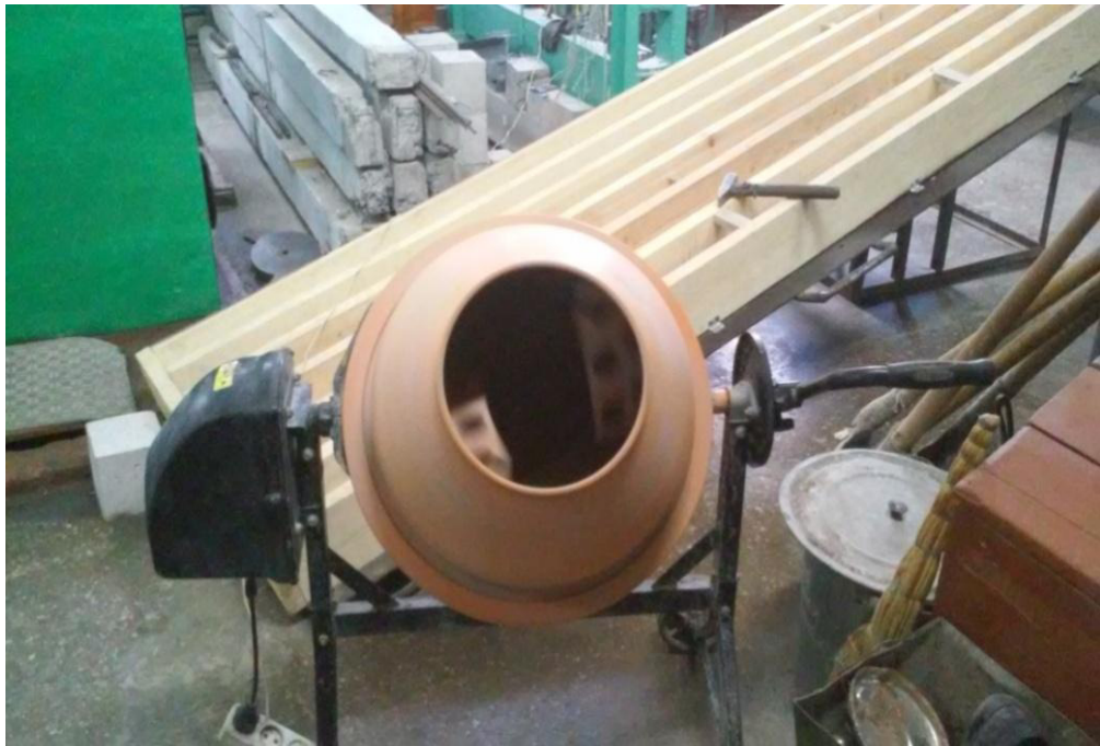
Рисунок 2.16 – Процес приготування бетонної суміші
