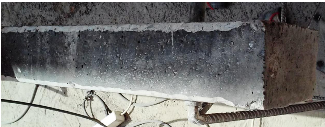
Рисунок 2.4 – Улаштування фаски на торцях балки
