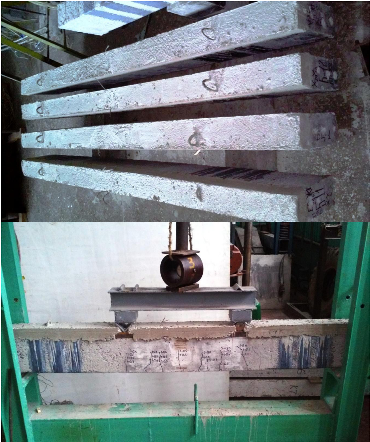
Рисунок 2.18 – Підсилені залізобетонні балки після демонтажу опалубки
