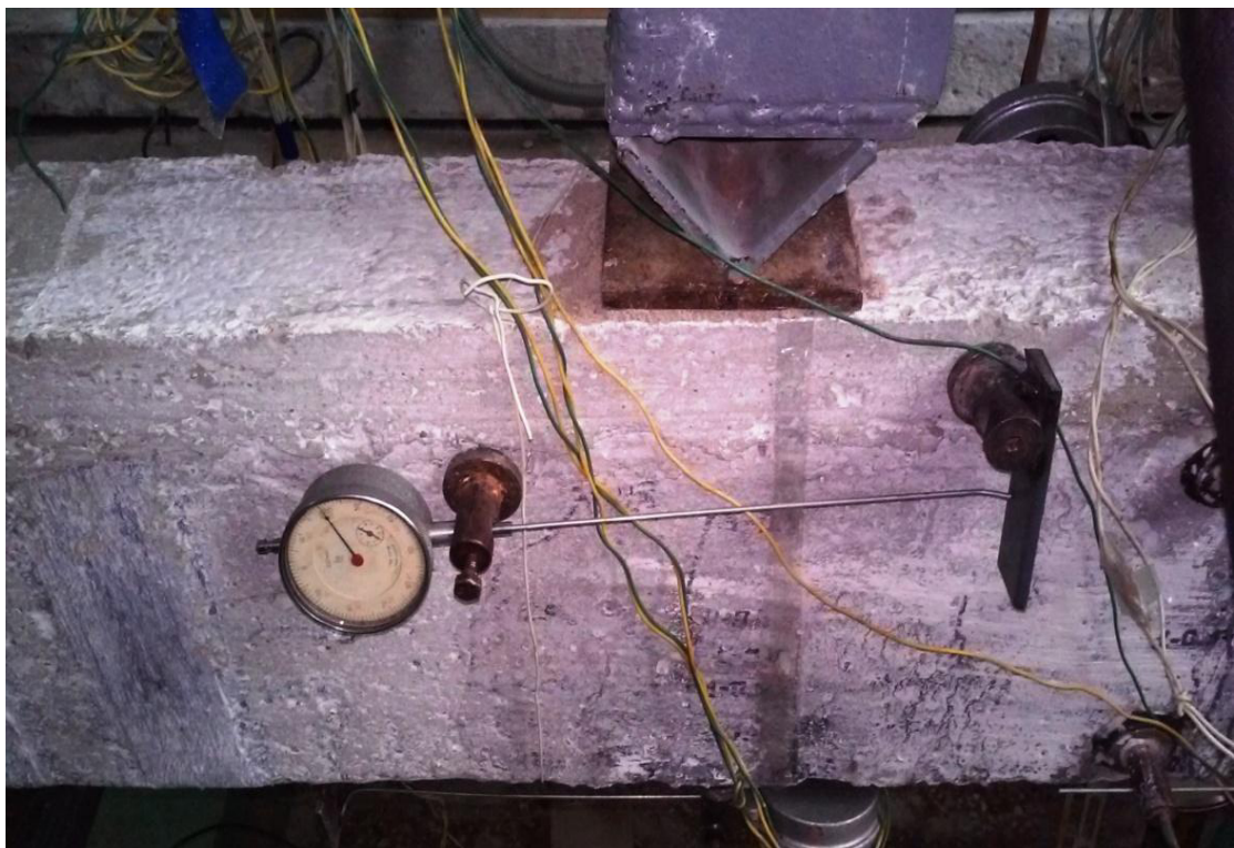
Рисунок 3.35 – Індикатори для виміру сумісного деформування бетону підсилення та бетону балки
