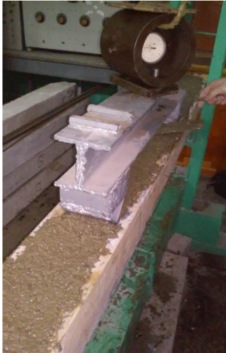
Рисунок 2.17 – Підсилення стиснутої зони балки під навантаженням
