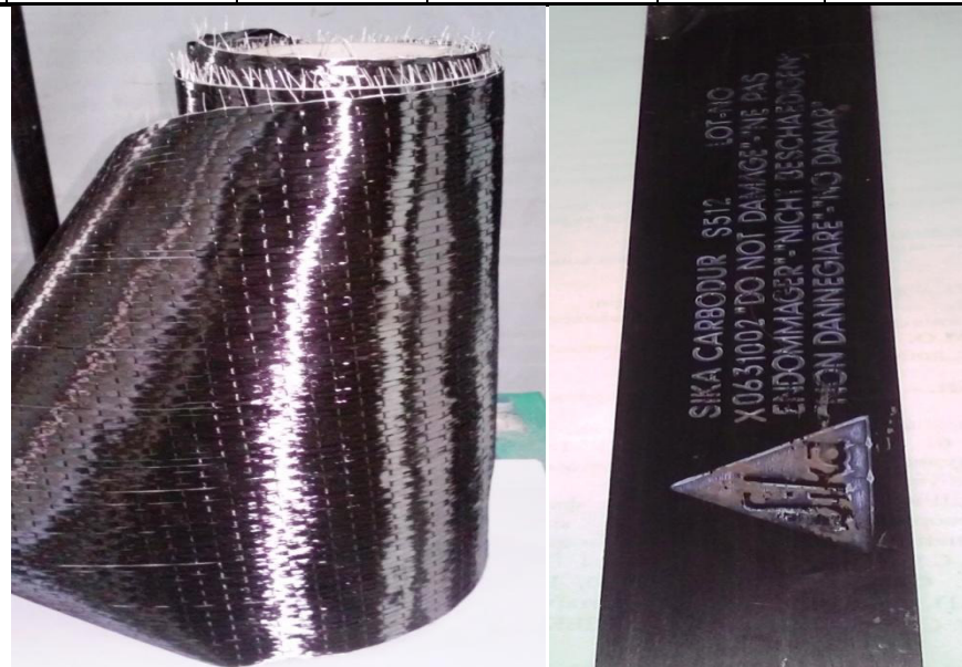
Рисунок 2.1 – Полотно SikaWrap®-230 C/45 та стрічка Sika® CarboDur® S-
