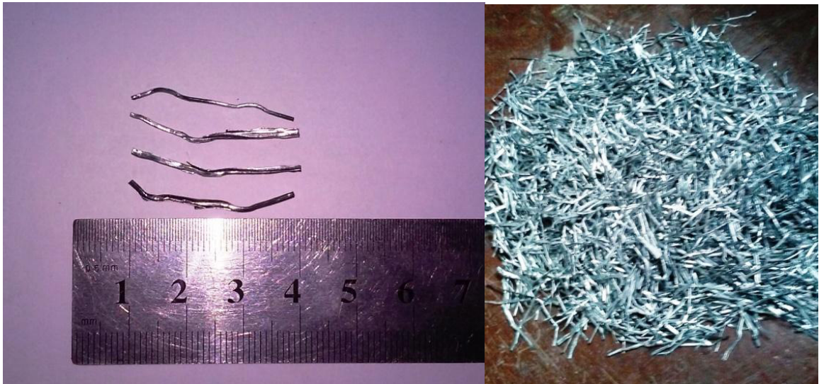
Рисунок 2.14 – Листова фібра оцинкована
