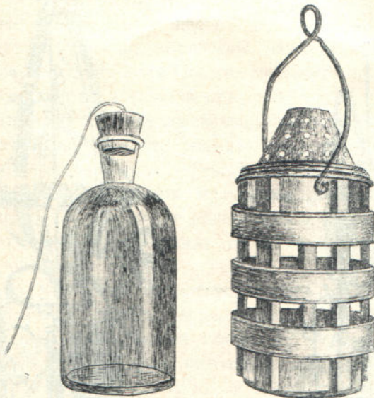
Рис. 31. Приборъ для взятія пробъ воды для химическаго изслѣдованія. 1. Стеклаянная бутылъ въ \frac{1}{4} — \frac{1}{2} ведра. 2. Футляръ, въ которомъ погружается бутылъ въ воду. Верхняя коническая часть футляра открывається. Русская модель.
