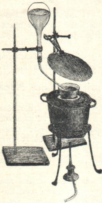
Рис. 38. Автоматическое выпариваніе воды. Трубка косо срѣзаннымъ нижнимъ концомъ слегка погружается въ воду.
