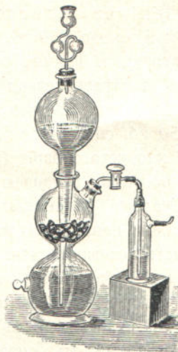
Рис. 49. — Прибор Киппа для получения углекислоты, водорода и других газовъ.
