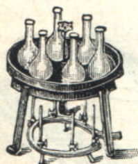
Рис. 42. Штативъ для разрушенія органическихъ веществъ по способу Кьельдаля.
