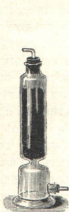
Рис. 48. Прибор с натронной известью для освобождения воздуха от углекислоты (башня).
