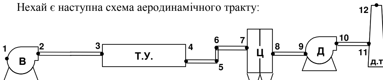
Рис. 4. Схема аеродинамічного тракту
