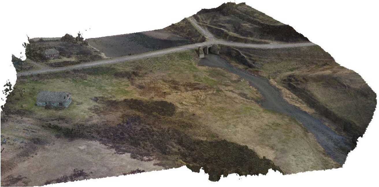
Рис. 2. 3D-модель за результатами дистанційної зйомки (DJI Phantom 3 Advanced, Н – 45 м)
