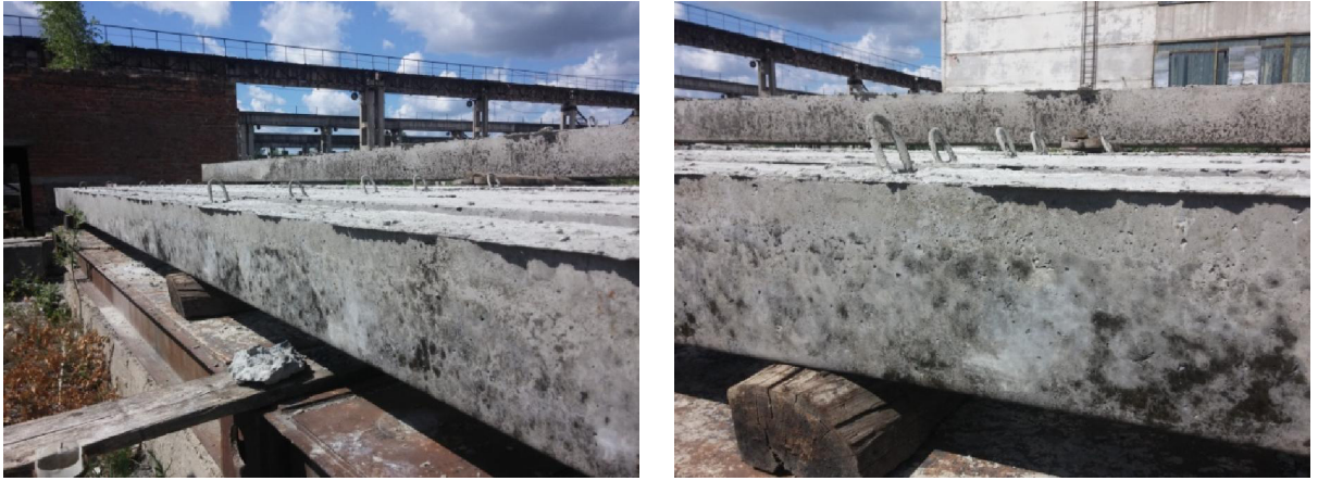
Рисунок 6.5 – Палі забивні С 90.30.9,1 виготовлені на основі запропонованих складів фібробетонних сумішей у виробничих умовах ПАТ "Рембуд" (м. Рівне)
