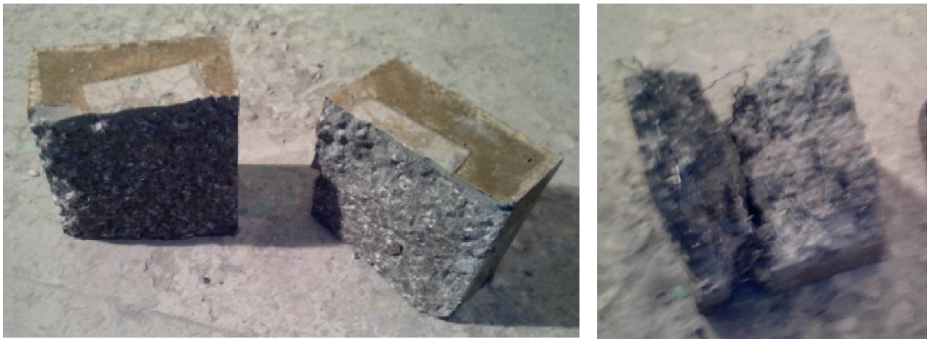
Рисунок 5.11 – Експериментальні зразки після випробування на ударну міцність:
