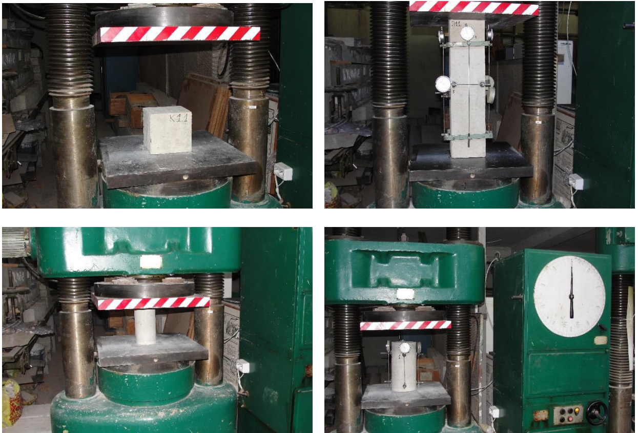
Рис. 2.15. Випробування бетонних кубів призм та циліндрів
