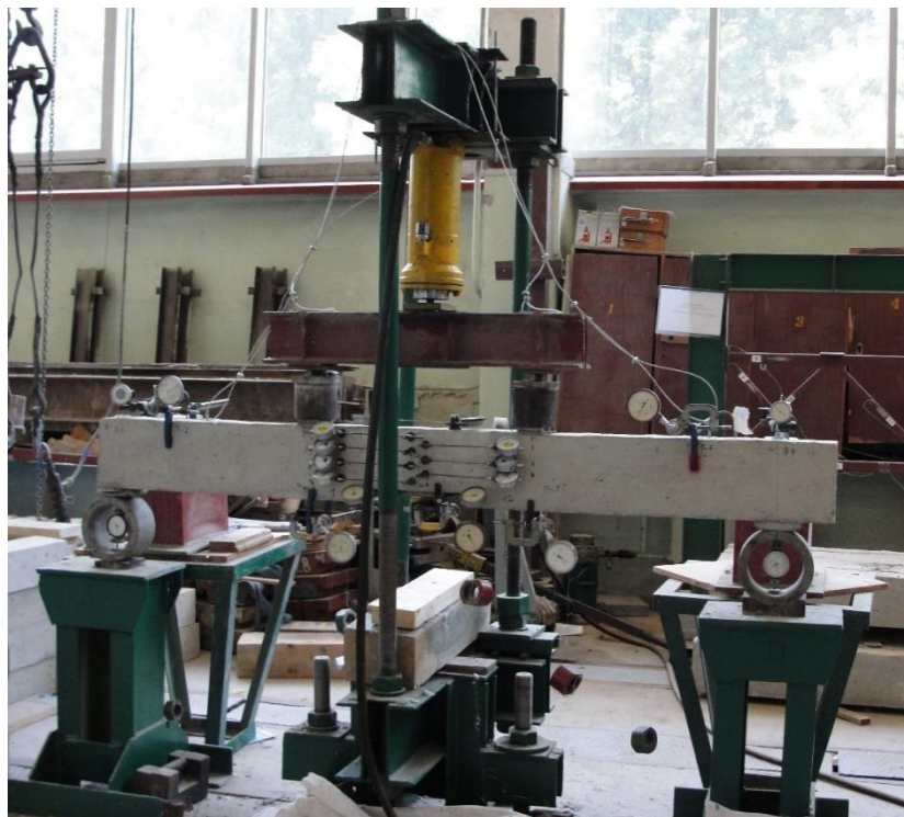
Рис. 2.13. Загальний вигляд стелду для випробування балок
