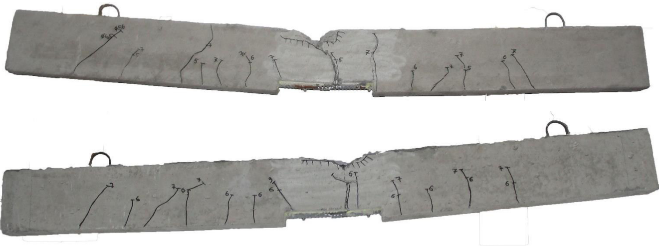
Рис. А.6. Характер утворення тріщин дослідних зразків БП-1.9-0.5* (зверху) та БП-1.10-0.5* (знизу)
