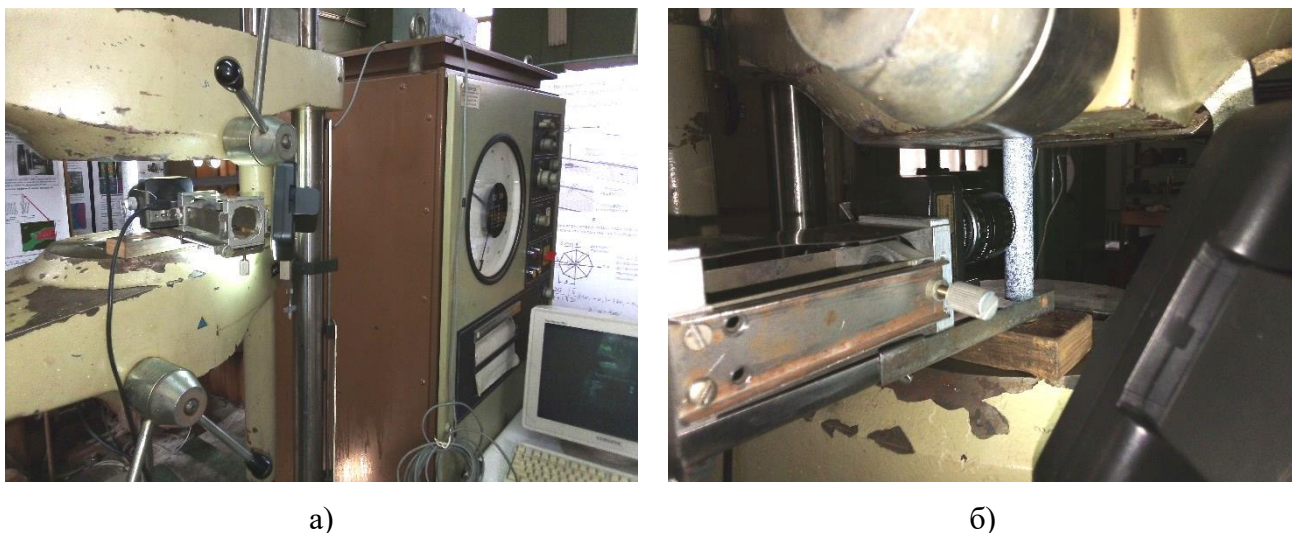
Рис. 2.23. Розривна машина EUS-20: а – загальний вигляд установки, б – зразок та цифрова камера для застосування методу кореляції цифрових зображень
