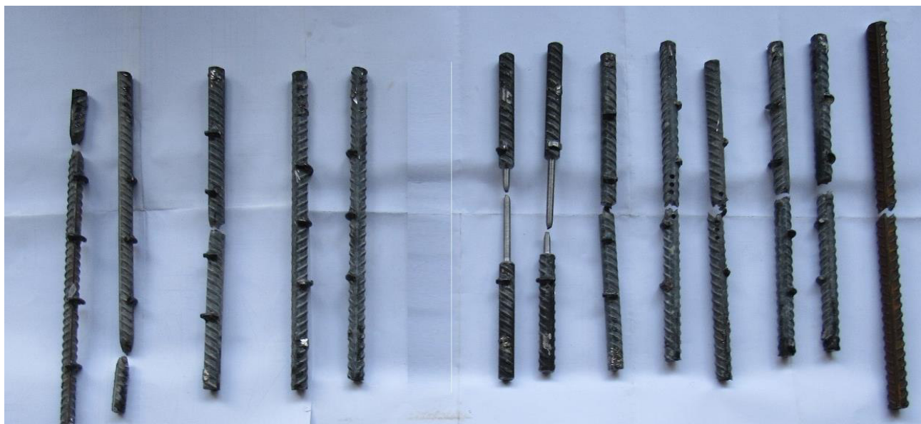
Рис. 2.31. Загальний вигляд зразків арматури з отворами та контрольні суцільні, відібрані з експериментальних балок.
