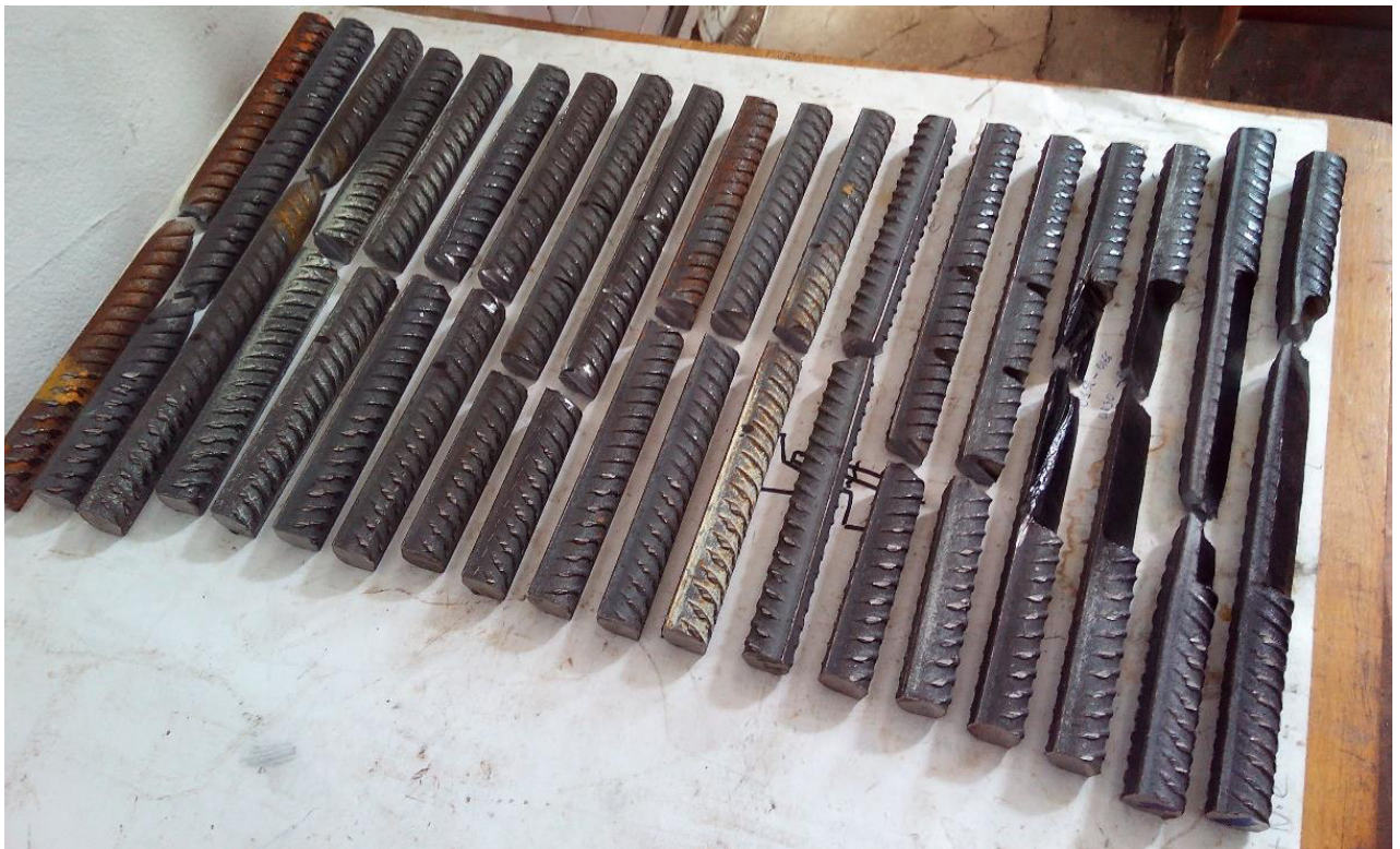
Рис. 2.19. Загальний вигляд зразків арматури з різними типами дефектів
