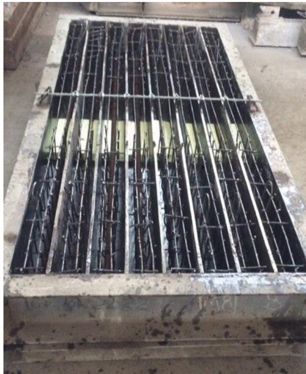
Рис. 2.7. Загальний вигляд каркасу дослідних зразків в опалубці
