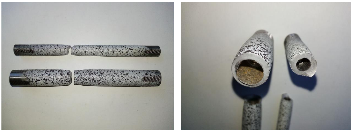
Рис. 2.25. Трубчасті зразки після випробувань статичним розтягом
