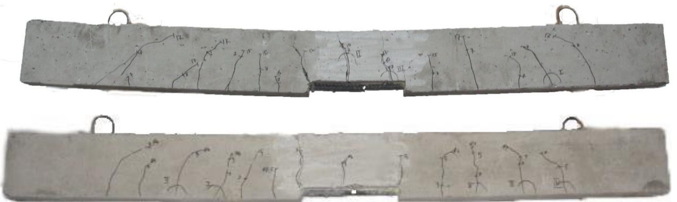
Рис. А.5. Характер утворення тріщин дослідних зразків БП-1.7-0.5 (зверху) та БП-1.8-0.5 (знизу)
