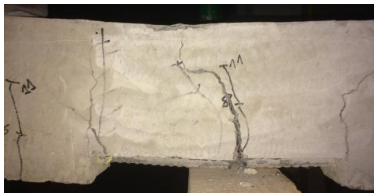
Рис. 3.4. Руйнування зразка БП-1.3, внаслідок розриву робочої арматури
