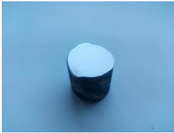
Рис. 2.21. Шліф для визначення мікротвердості поперечного січення арматури.
