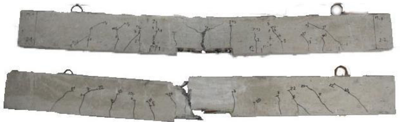
Рис. А.8. Характер утворення тріщин дослідних зразків БП-3.15-0.5 (зверху) та БП-3.16-0.5 (знизу)
