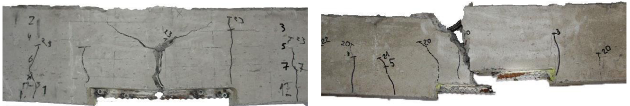
Рис. 3.39. Характер утворення тріщин центрального перерізу дослідного зразка БП-3.15-0.5 (зліва) та БП-3.16-0.5 (справа)
