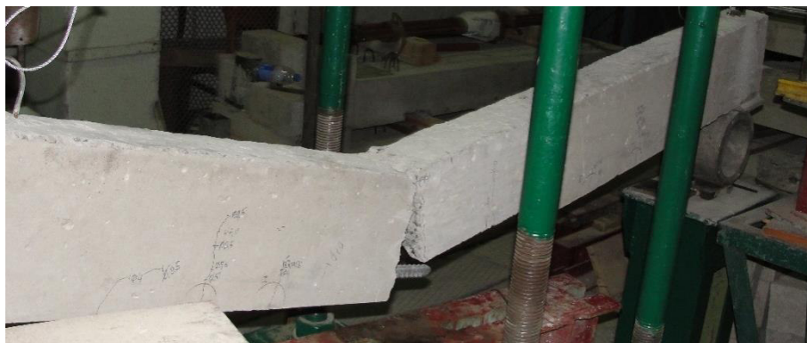
Рис. 3.7. Руйнування зразка БП-1.6-0.3, внаслідок розриву робочої арматури
