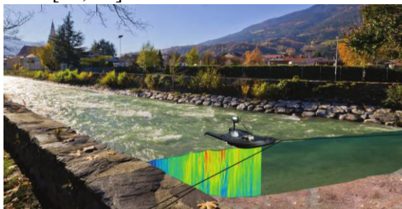
Рис. 3. Акустичний доплерівський профілограф швидкості течії серії RiverSurveyor з функцією визначення витрати. Фото з сайту: http://www.demetra5.kiev.ua/ru/catalog/ADV_Sontek/RiverSurveyor
