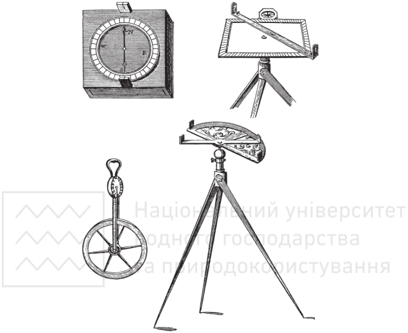
Рис. 56. Інструментарій для виконання топографічного картографування у польових умовах
