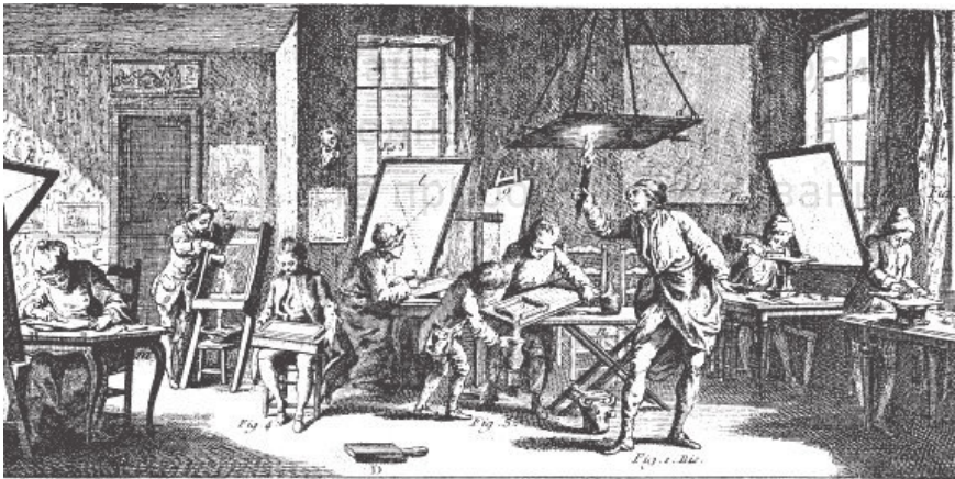
Рис. 42. Підготовка і гравірування мідної друкувальної форми на картографічному підприємстві
