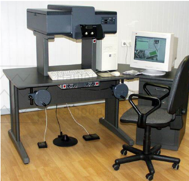
Рис. 74. Аналітична фотограмметрична станція «Стереанаграф»
