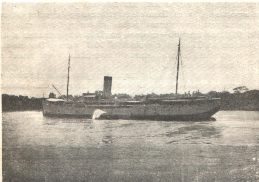
Рис. 53. Землесосъ, сосущій на ходу, на работѣ въ Каналѣ.
