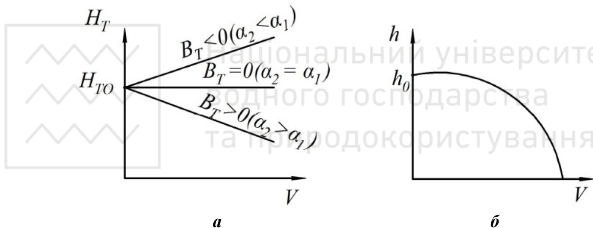
Рис. 8.3. Напірні лінії: а - теоретичні; б - дійсна
