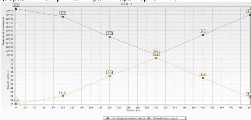
Рис. 4. Профіль водопровідної мережі по контуру (B-1 – B-6) в програмному комплексі WaterGEMS
