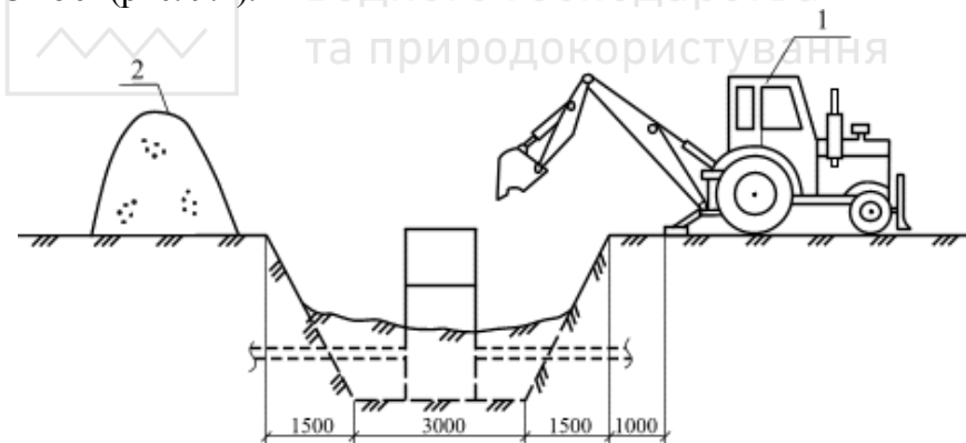
Рис. 9.2. Схема відкопування колодязя екскаватором ЕО-262ІА. 1 - екскаватор ЕО-262ІА; 2 – тимчасовий відвал ґрунту
