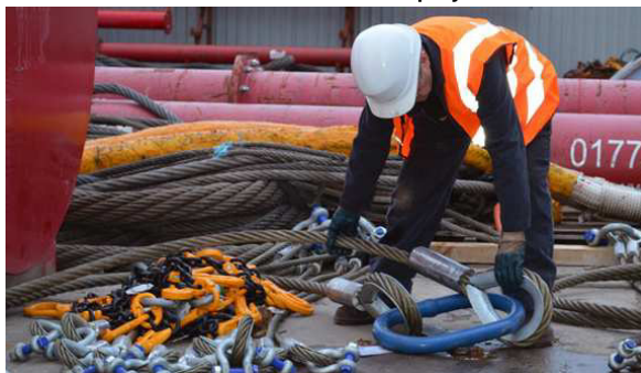
Рис. 2. Візуальний контроль троса крана
