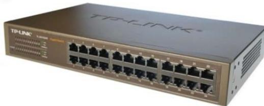
Рис 1. Комутатор TP-LINK TL-SG1024D
