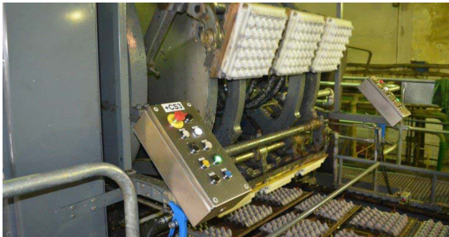
Рис. 2. Перекладання лотка на транспортер у сушку за допомогою форм млина та вакуума
