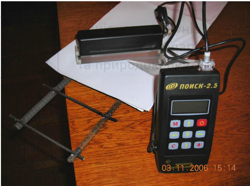
Рис.1.18. Вимірювач захисного шару бетону "ПОИСК-2.5": а – електронний блок вимірювань; б – виносний індуктивний датчик; в - 20-мм прокладка - еталон
