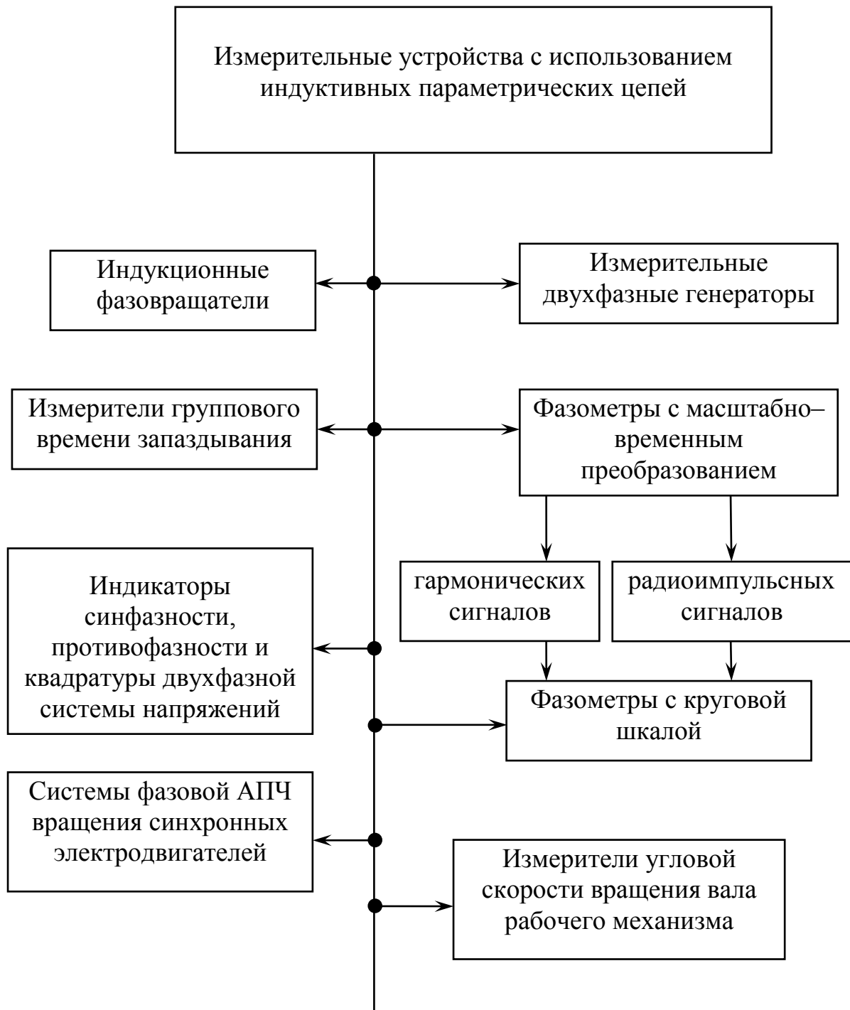
Рис.1.2. Классификация устройств измерения фазовых и временных параметров радиосигналов с применением ИПЦ
