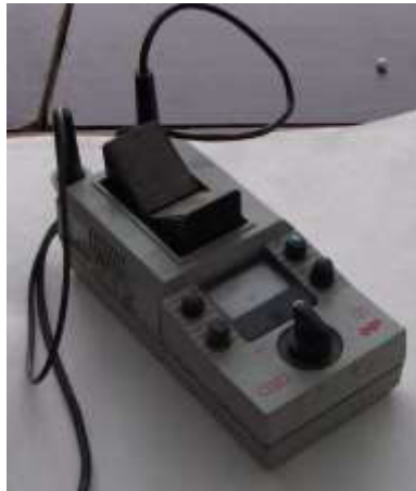
Рис. 4.9. Прилад для перевірки якорів генераторів і стартерів моделі Е-236:
