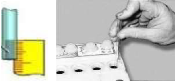
Рис. 4.5. Вимірювання рівня електроліту в аккумуляторній батареї скляною трубкою
