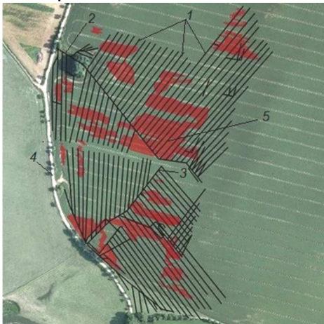
Рис. 6. Схема осушувальної системи з закритим дренажем: 1 – дрени; 2, 3 – закриті колектори (трубопроводами-збирачі); 4 – відкритий колектор (ріка); 5 – ділянки з високим рівнем ґрунтових вод (світлина взята з сайту https://twitter.com/Apus_Systems/status/969611876626812928 )
