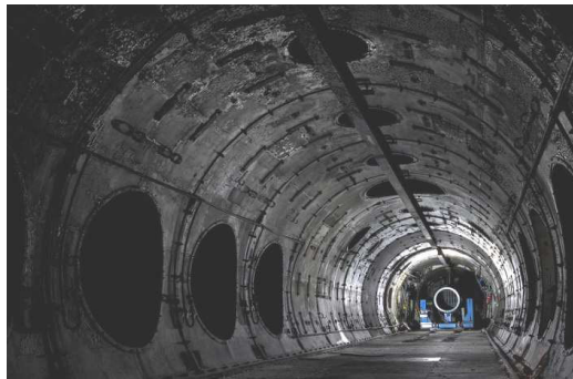
Рис. 13. Випробувальна камера для реактивних двигунів: на задньому плані розміщено стенд для двигуна, котрий досліджують (світлина взято з сайту http://imagestun.com/vsya-krasota-zabroshennih-zdaniy/ )
