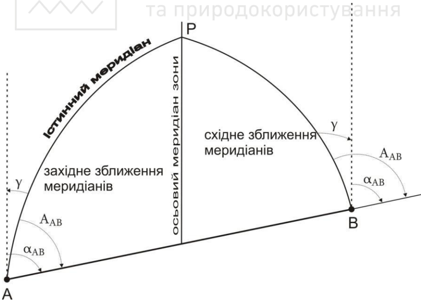
Рис. 4.8. Схема визначення орієнтирних кутів напрямку
