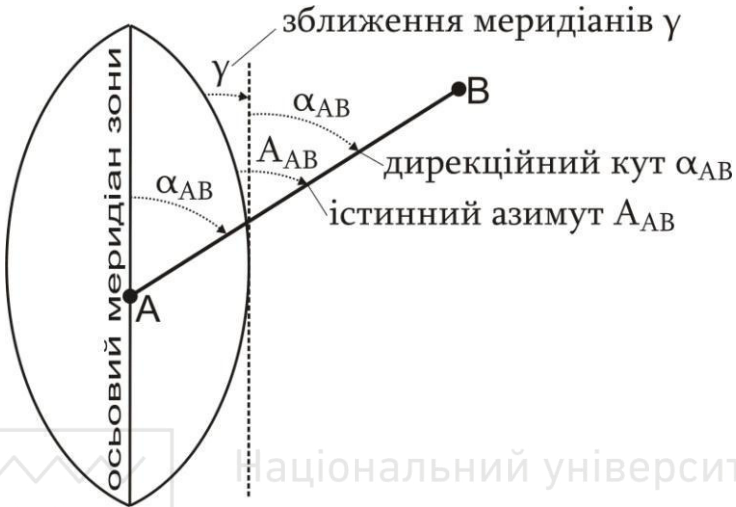
Рис. 4.7. Зв'язок між дирекційними кутами та істинними азимутами
