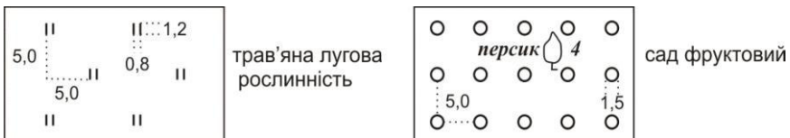
Рис. 1.1. Приклад контурних (масштабних) умовних знаків для масштабу 1:500 та 1:1000
