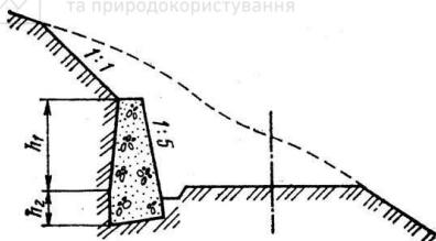
Рис. 1.8. Підпірна стінка для укріплення нестійких нескельних укосів напіввійми
